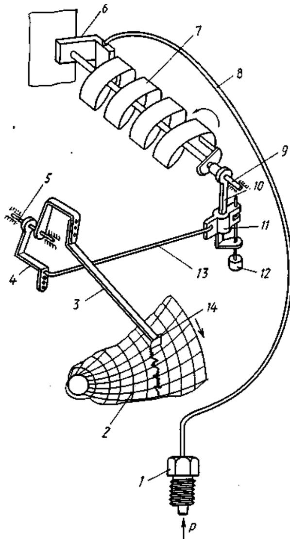
Рисунок 12.3 – Схема самопишущего манометра с многовитковой трубчатой пружиной
