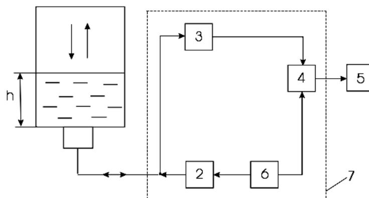
Рисунок 10.31 – Схема ультразвукового уровнемера
