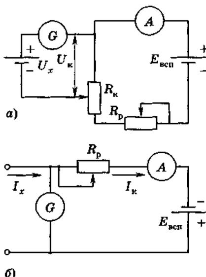
Рисунок 6.1 – Схемы компенсации напряжений (а) и токов (б)
