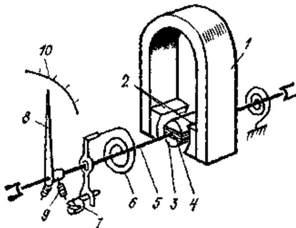
Рисунок 7.1 – Конструкция магнитоэлектрического преобразователя
