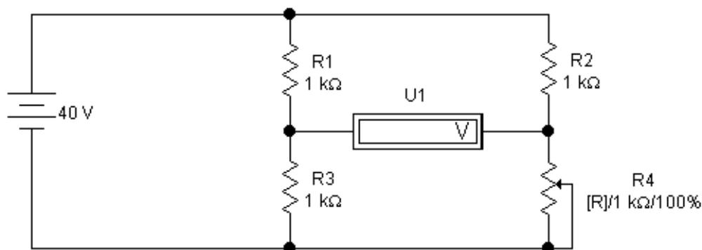
Рисунок 5.2 – Схема исследуемого одинарного моста постоянного тока
