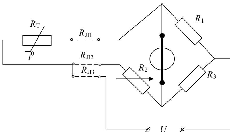
Рисунок 10.6 – Трехпроводная схема измерительного моста термометра сопротивления
