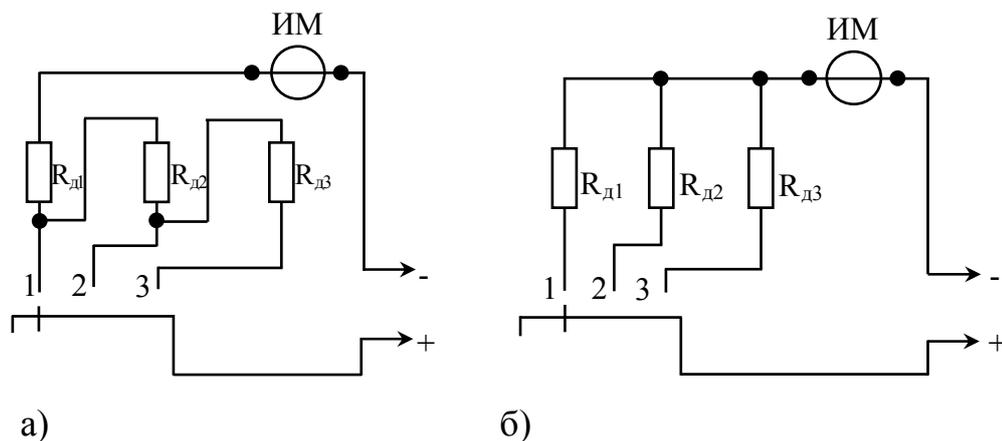
Рисунок 3.5 – Схемы многопредельных вольтметров постоянного тока
