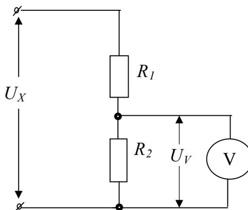
Рисунок 6.7 – Схема включения делителя напряжения
