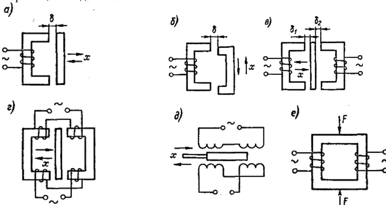
Рисунок 10.2 – Различные конструкции индуктивных преобразователей
