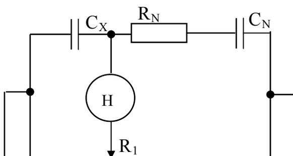
Рисунок 11.3 – Схема моста Вина
