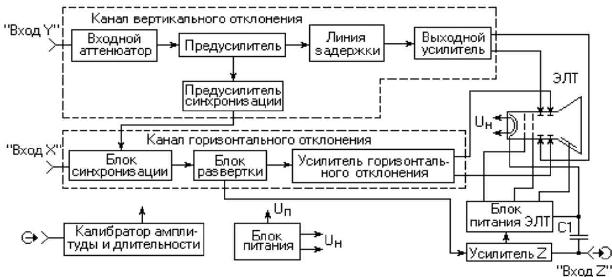
Рисунок 2.1 – Структурная схема универсального электронно-лучевого осциллографа
