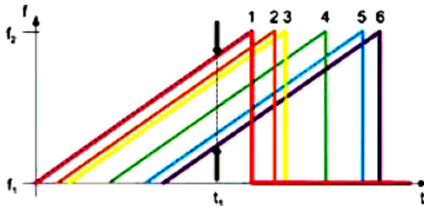
Рисунок 10.36 – Отражения при использовании технологии *FMCW*:
