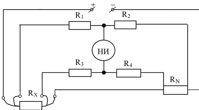
Рисунок 11.4 – Схема моста Томсона
