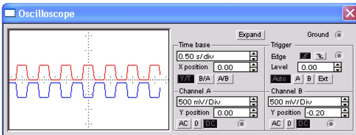
Рисунок 3.4 – Лицевая панель осциллографа
