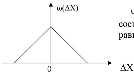
Частный случай трапецевидного, когда составляющие имеют одинаковые равномерные законы распределения.
