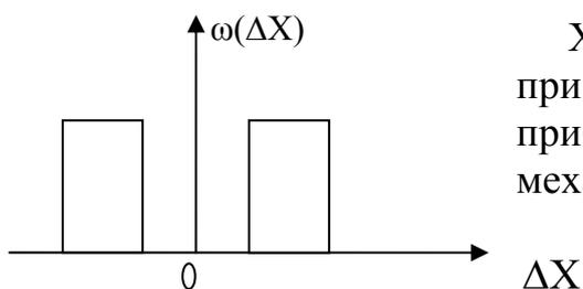
Характерен для приборов с гистерезисом при перемагничивании деталей прибора, для приборов, имеющих люфт кинематических механизмов и т.д.
