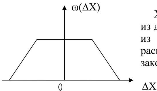
Характеризует погрешность, образуемую из двух независимых составляющих, каждая из которых имеет равномерный закон распределения, но ширина интервала этих законов различна.
