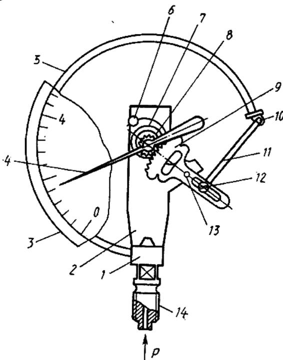
Рисунок 10.17 – Схема манометра с одновитковой трубчатой пружиной
