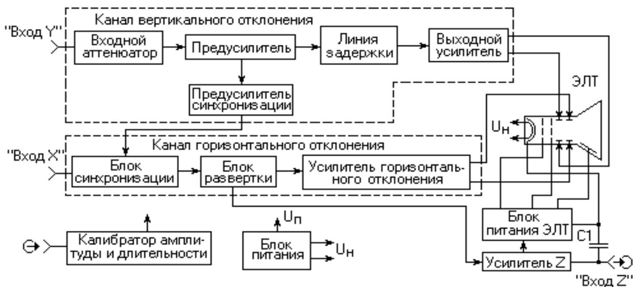
Рисунок 8.1 – Структурная схема универсального электронно-лучевого осциллографа
