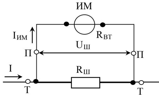
Рисунок 3.1 – Схема соединения измерительного механизма с шунтом
