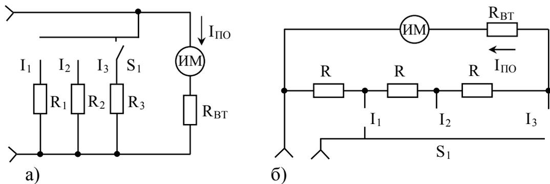
Рисунок 3.2 – Схема многопредельного миллиамперметра:
