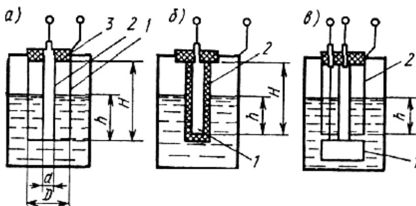
Рисунок 10.30 – Схемы емкостных уровнемеров
