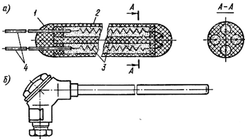
Рисунок 10.5 – Устройство и внешний вид арматуры платинового терморезистора
