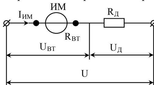
Рисунок 3.4 – Соединение измерительного прибора с добавочным резистором
