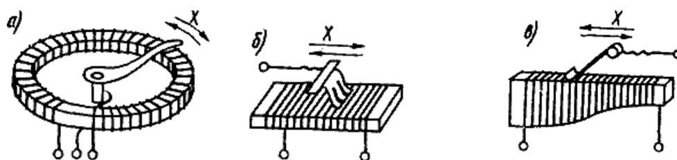
Рисунок 10.1 – Реостатные преобразователи для угловых и линейных перемещений
