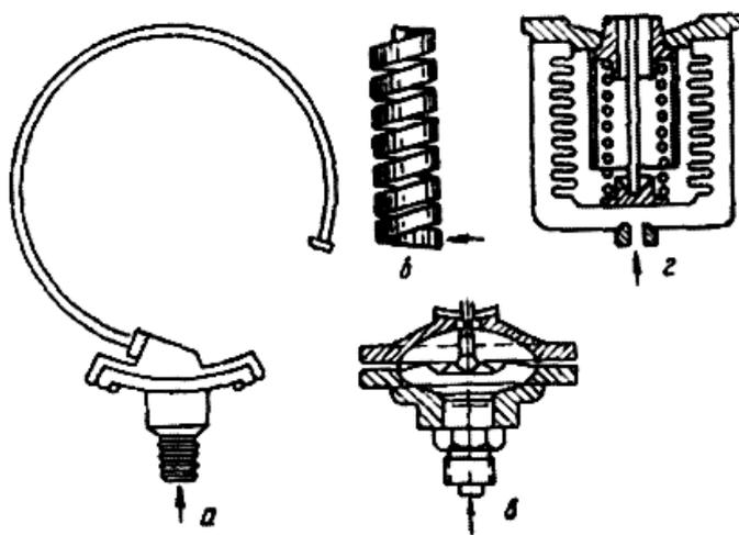
Рисунок 10.16 – Упругие элементы: а – трубчатая пружина; б – много-
