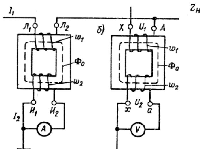
Рисунок 6.9 – Схема включения измерительных трансформаторов
