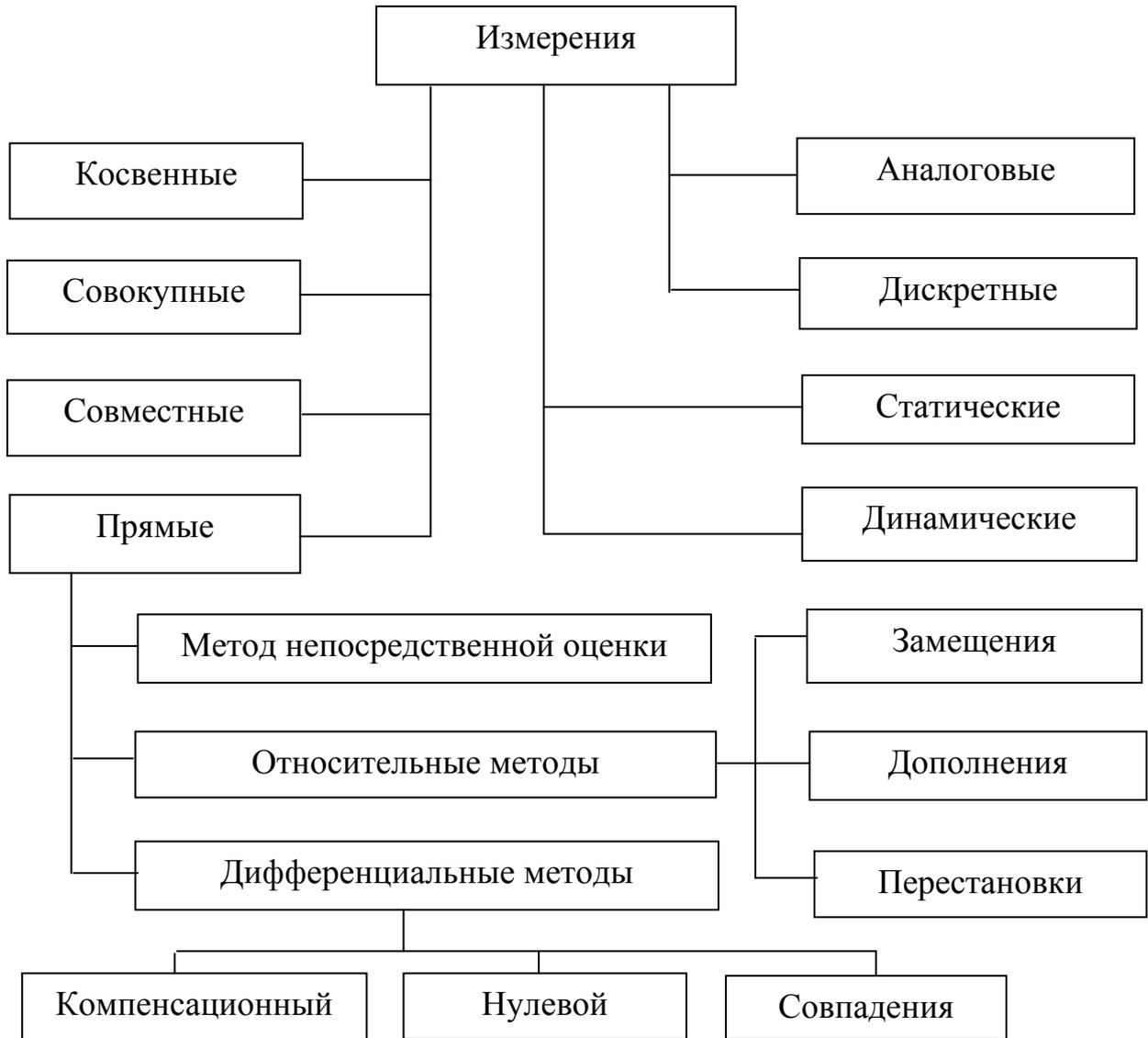
Рисунок 2.1 – Классификация измерений
