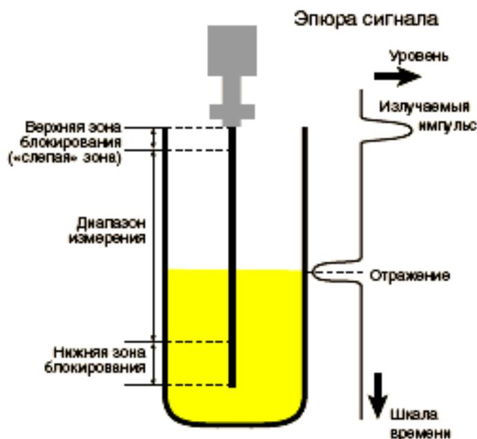
Рисунок 10.35 – Метод направленного электромагнитного излучения
