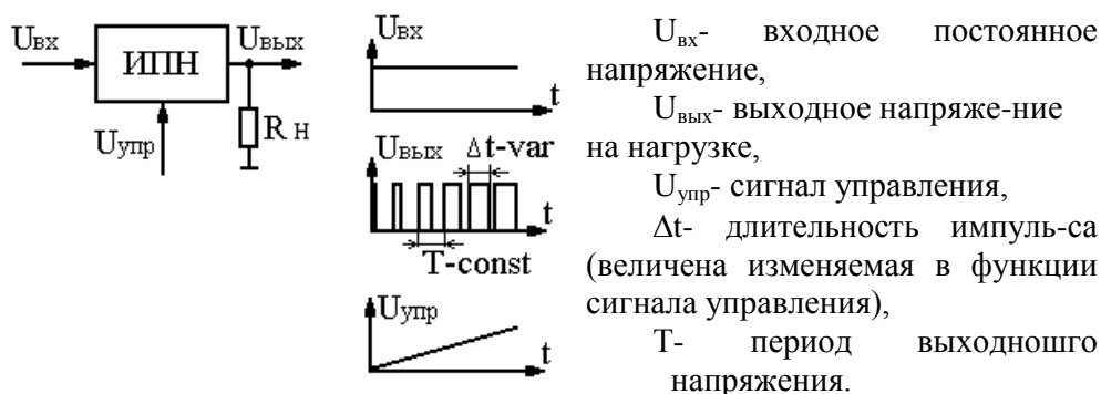
Рисунок 2. Функциональная схема импульсного преобразователя напряжения.
