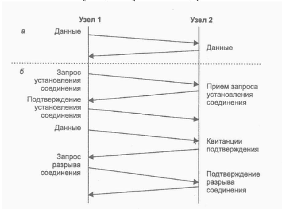
**Рис. 7.3.** Протоколы без установления соединения (а) и с установлением соединения (б)
