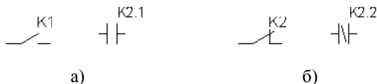
Рисунок 3.4 – Графическое обозначение контактов в языке LD (слева) и соответствующее им общепринятое обозначение а) – прямой (замыкающий) контакт; б) – инвертированный (размыкающий) контакт.
