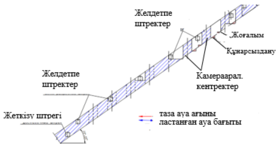
Сурет 4.1- Көлбеу кен орындарын игеруге арналған панельдік-бағаналы жүйе
