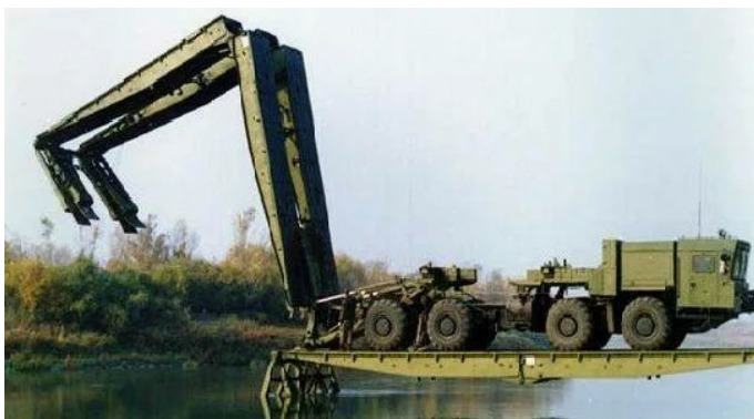
а) Процесс наведения моста
