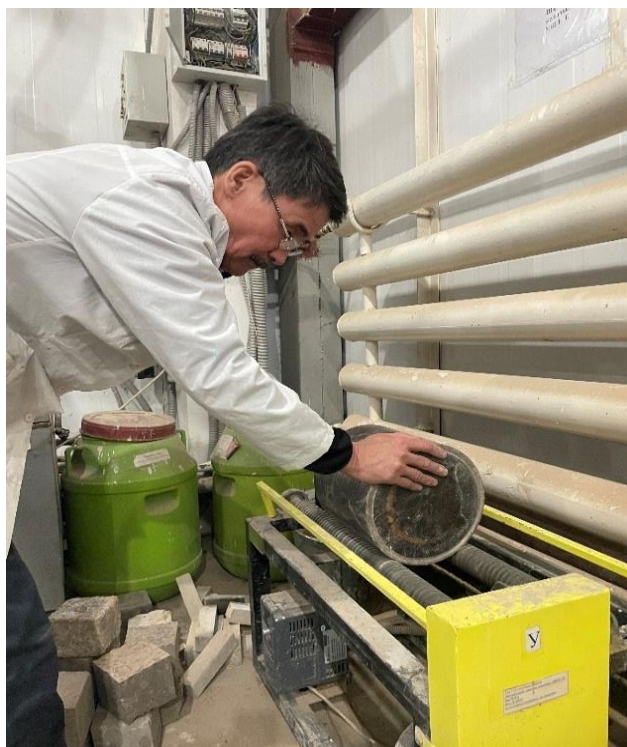
Сурет 6 - МШЛ-1П маркалы зертханалық шар диірменіндегі шикізатты ұнтақтау процесінің фрагменттері
