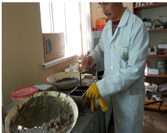
Сурет 43- Жобаланған құрам бойынша бетон араласпасын дайындау процесі
