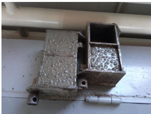
Сурет 43- Жобаланған құрам бойынша бетон араласпасын дайындау процесі
