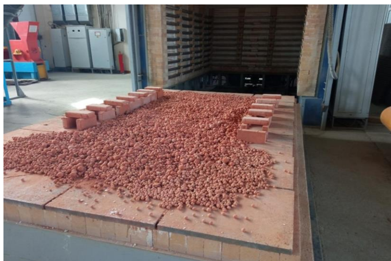
Сурет 40 - Жылжымалы паллетті камералық пеште күйдірілген керамикалық толтырғыштардың жалпы көрінісі
