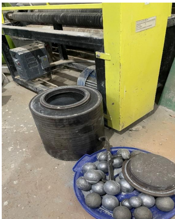
Сурет 6 - МШЛ-1П маркалы зертханалық шар диірменіндегі шикізатты ұнтақтау процесінің фрагменттері
