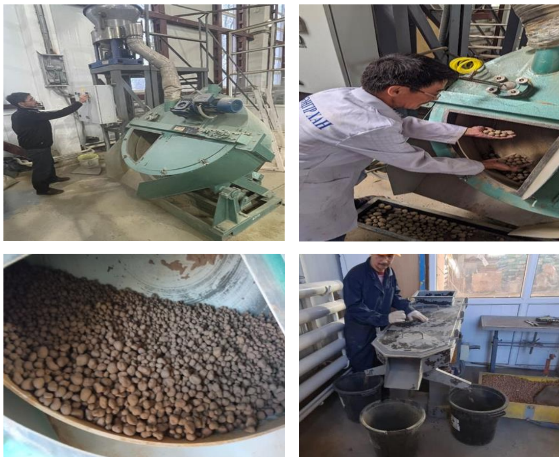
Сурет 8 - Т-100 маркалы жартылай өнеркәсіптік табақша түйіршіктеу жабдығы
