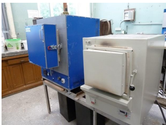
Рисунок 2.6 – Лабораторные печи с нихромовыми (а) и карбидкремниевыми (б) нагревателями
