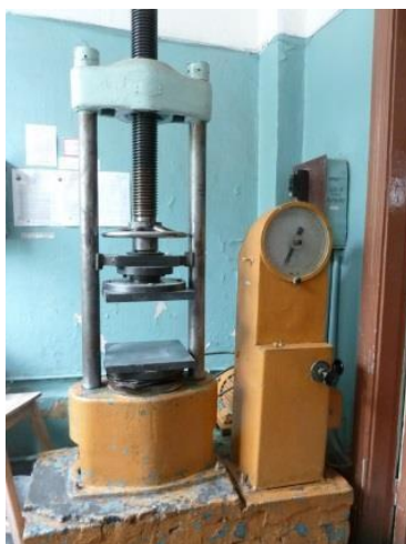
Рисунок 2.5 – Пресс лабораторный испытательный ИП-50 Линейную усадку или рост определяли согласно ГОСТ 5402.1-2000
