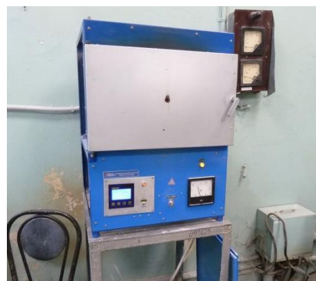
Рисунок 2.6 – Лабораторные печи с нихромовыми (а) и карбидкремниевыми (б) нагревателями
