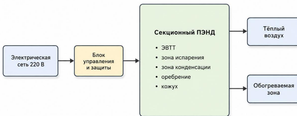
Рисунок 4.1 – Обобщенная конструктивно-функциональная схема ПЭНД как секционного отопительного прибора
