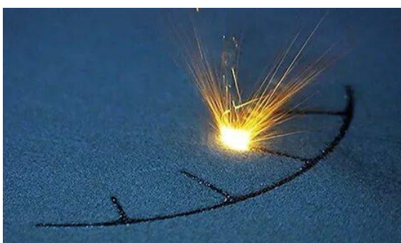
Сурет 1.3 – Металл ұнтағын селективті лазерлік жентектеу (SLS) процесі
