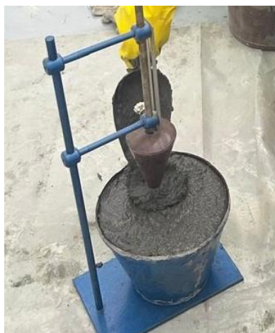
Сурет 3.3 – Ерітінді қоспасының қозғалғыштығын конусты батыру әдісімен анықтау
