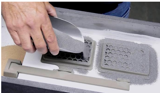
Сурет 1.4 – Бұйымды ағынды байланыстыру әдісімен қалыптастыру процесі (Binder Jetting)
