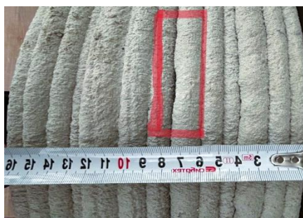
Сурет 5.15 – Қабаттар арасындағы үзілістер.
