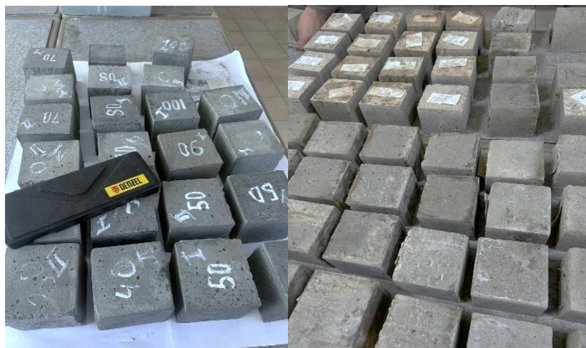
Сурет 4.5 — Қалыптан шығарылғаннан кейінгі үлгілердің сыртқы көрінісі
