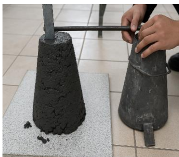
Сурет 4.1 – Бетон қоспасының шөгуін конусты бату әдісімен анықтау
