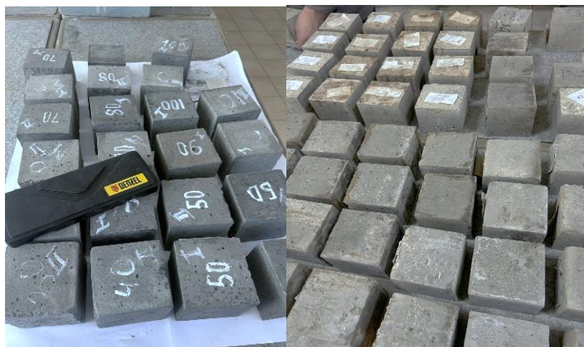
Сурет 4.5 — Қалыптан шығарылғаннан кейінгі үлгілердің сыртқы көрінісі
