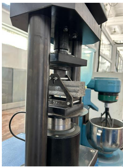
Сурет 4.6 – Иілу кезіндегі беріктікті анықтау (ПГМ-1000МГ4 гидравликалық пресі)
