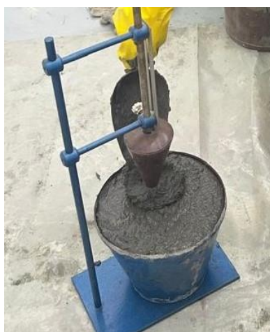
Сурет 3.2 – Ерітінді қоспасының қозғалғыштығын конусты батыру әдісімен анықтау
