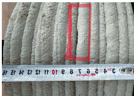
Сурет 5.15 – Қабаттар арасындағы үзілістер.
