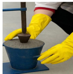
Сурет 4.2 – Бетон қоспасының экструзияланғыштығын бағалау үшін конустың бату тереңдігін (ПГР) анықтау
