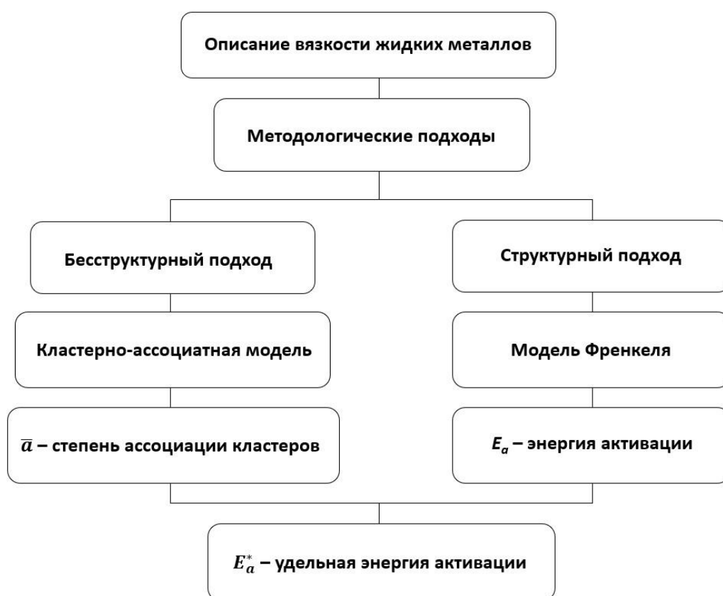
Рисунок 3.8 – Схема описания температурной зависимости вязкости жидких расплавов на основе двух методологических подходов: структурного (модель Френкеля) и энергетического (кластерно-ассоциатная модель)
