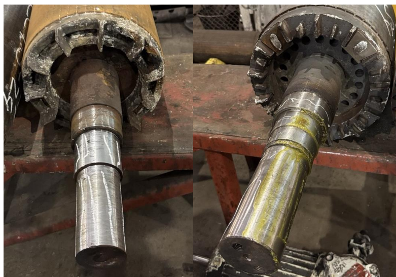
Рисунок 1.7 – Разрушение валов электродвигателей из-за износа
