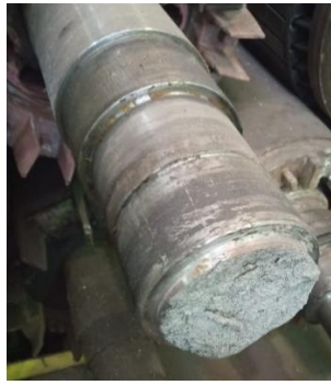
Рисунок 1.10 - Поломка валов электродвигателей из-за усталости
