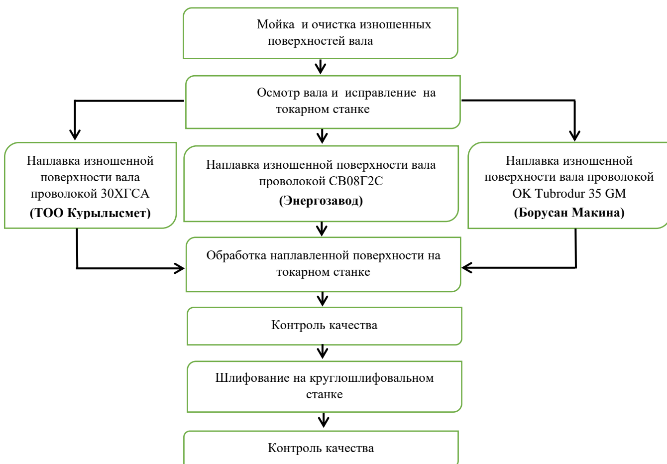
Рисунок 1.15 – Технологический процесс восстановления вала на ремонтных предприятиях города Караганды
