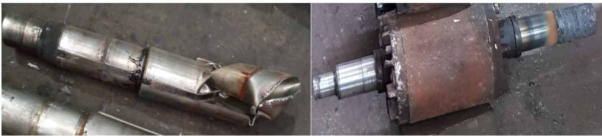
Рисунок 1.11 - Поломка валов электродвигателей из-за перегрузки
