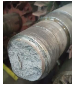
Рисунок 1.10 - Поломка валов электродвигателей из-за усталости
