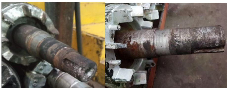
Рисунок 1.8 – Коррозия и износ из-за повышенной влажности
