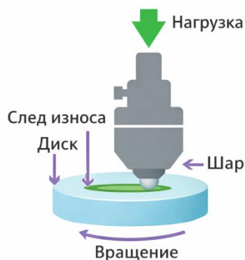
Рисунок 2.17– Схема трения «шарик-диск»
