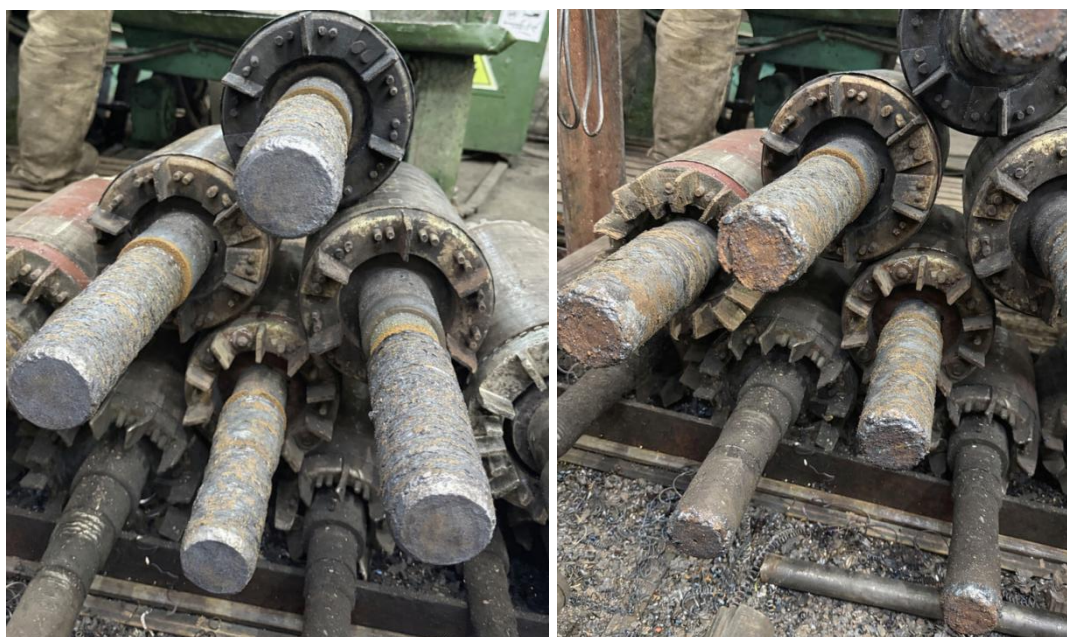
Рисунок 1.17 – Наплавленные валы электродвигателей на Энергозаводе (г. Караганда)
