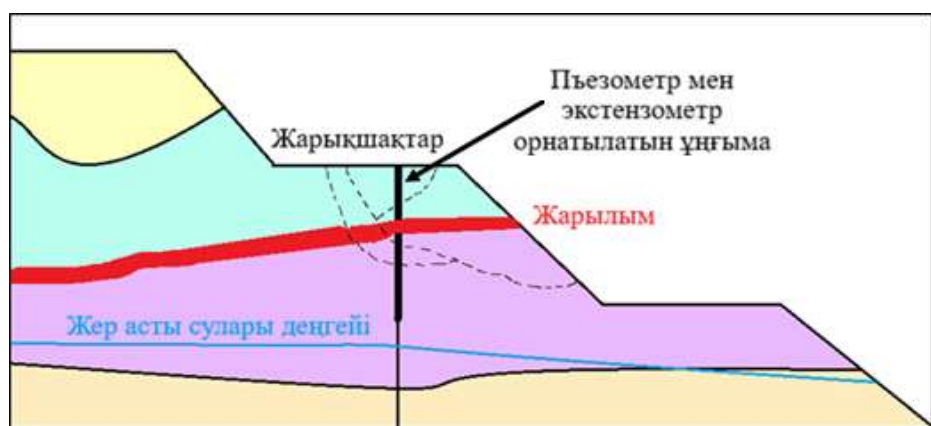
1.10-сурет – Пьезометрлер мен экстензометрлерді орнату сызбасы
