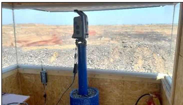
4.3-сурет – Карьер беткейінде орналасқан контейнер ішіндегі автоматтандырылған тахеометр
