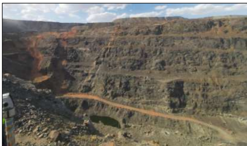
1.13-сурет – Карьердің солтүстік-батыс беткейі (қатты жыныстардағы кемердің қосарланған қиябеттері)
