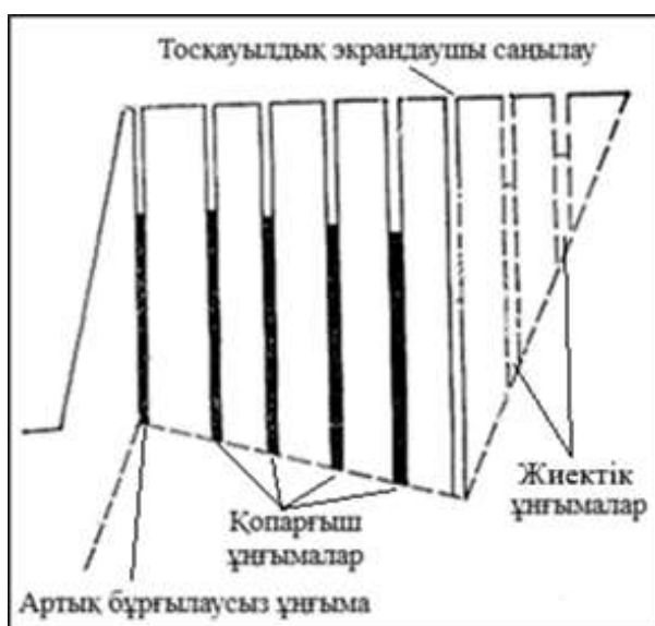
1.7-сурет – Кемерлер қиябеттерін шығару әдісі (Галустьян Э.Л. патенті 1980 ж.)
