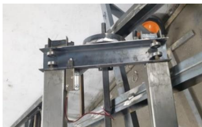
Сурет 4.6 – Мобильді жол өтпесінің жылжымалы кареткасын құрастырудың кезеңдері
