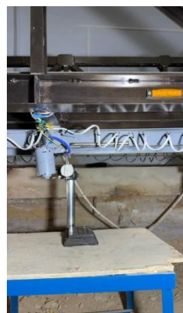
Сурет 4.24 – Осьтерді жылжыту балкасының иілуін өлшеу үшін орнатылған сағаттық типті индикатор
