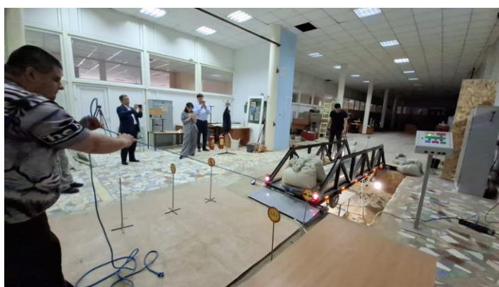
Сурет 4.38 – Эсперименттің екінші кезеңінде зерттеу тобының жұмысы (осьтерді жылжыту балкасының иілуін өлшеу)
