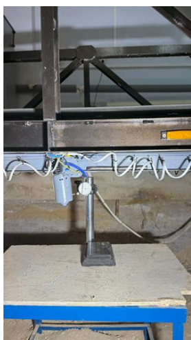
Сурет 4.37 – ИЧ-10 сағаттық типті индикаторды мобильді жол өтпесінің осьтерді жылжыту балкасына орнатылуы
