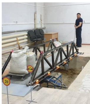
Сурет 4.31 – Арқанның көмегімен оператордың жүктемелік арбаны қолмен жылжытуы
