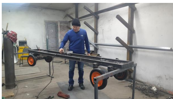
Сурет 4.7 – Жылжымалы каретканың құрастырылған күйдегі конструкциясы (жалпы көрінісі және артқы ось)
