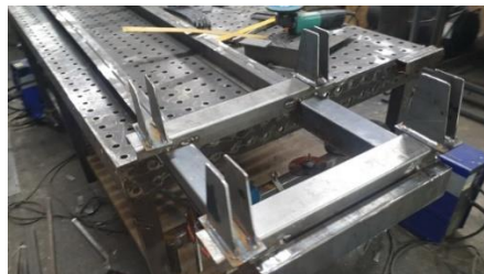
Сурет 4.6 – Мобильді жол өтпесінің жылжымалы кареткасын құрастырудың кезеңдері
