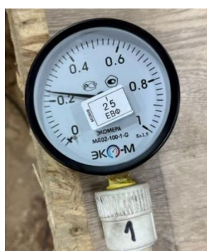
Сурет 4.23 – Эксперименттің бірінші кезеңінде өлшеу аспабының көрінісі (№1 және №2 манометрлер, «ЭКОМЕРА МД02-1001-G» моделі)
