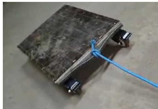
Сурет 4.19 – Жүктемелік қаптармен жабдықталған көлік құралын модельдеуге арналған жүктемелік арба
