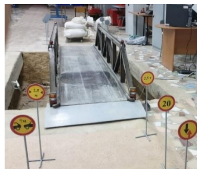
Сурет 5.7 – Мобильді жол өтпесінде қозғалысты эксперименттік модельдеу кезінде қолданылған жол белгілері (кішірейтілген масштабта).
