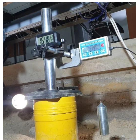
Сурет 4.41 – Стендке орнатылған ПСК-МГ4 прогибомері
