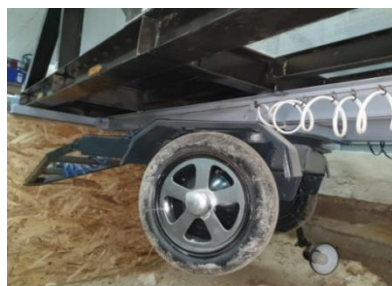
Сурет 4.11 – Қос таврлы балка бойымен қозғалатын алдыңғы және артқы осьтер
