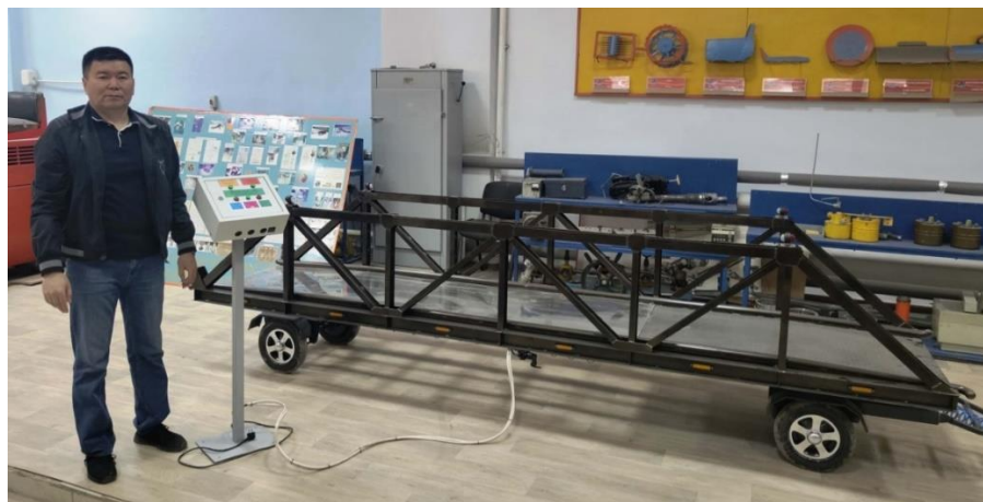
Сурет 4.17 – Мобильді жол өтпесінің эксперименттік стендінің тасымалдау жағдайындағы көрінісі
