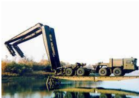
Сурет 1.11 – ТММ-6 (ТММ-3) ауыр механикаландырылған көпірі
