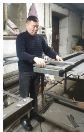
Сурет 4.5 – Жүріс бөлігінің қос таврлы балкаларын дайындау және монтаждау
