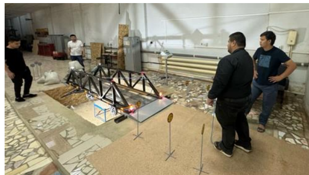
Сурет 4.33 – Мобильді жол өтпесінің стендінде эксперименттік өлшеулер жүргізу сәті
