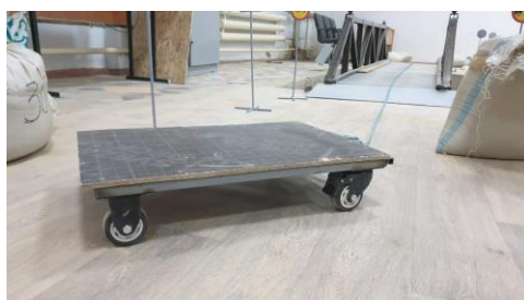
Сурет 4.28 – Мобильді жол өтпесіне кірер алдындағы жүктемелік арбаның орналасуы
