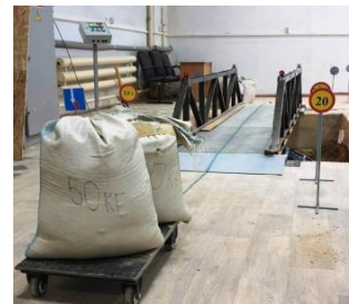
Сурет 4.28 – Мобильді жол өтпесіне кірер алдындағы жүктемелік арбаның орналасуы
