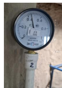
Сурет 4.32 – Мобильді жол өтпесінің жоғарғы платформасына түсетін жүктемелерді тіркеу үшін манометрлердің орналасуы
