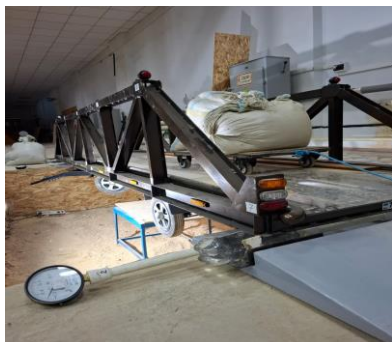
Сурет 4.33 – Мобильді жол өтпесінің стендінде эксперименттік өлшеулер жүргізу сәті
