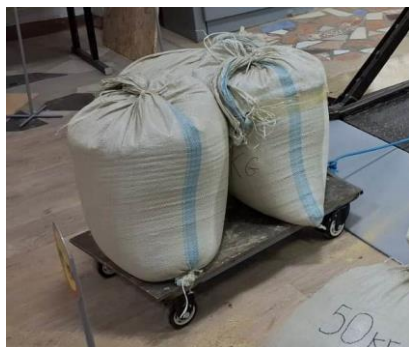
Сурет 4.19 – Жүктемелік қаптармен жабдықталған көлік құралын модельдеуге арналған жүктемелік арба
