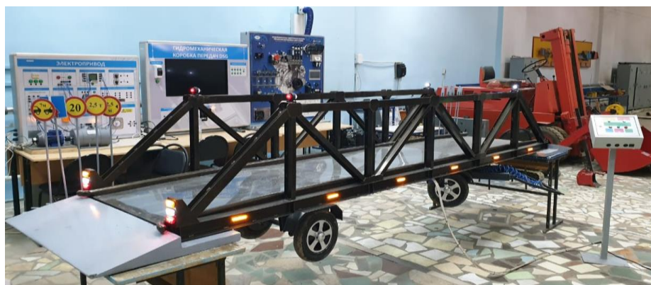
Сурет 4.15 – «КТжәнеЛЖ» кафедрасының зертханасында (155 аудитория) орнатылған мобильді жол өтпесінің эксперименттік стенді
