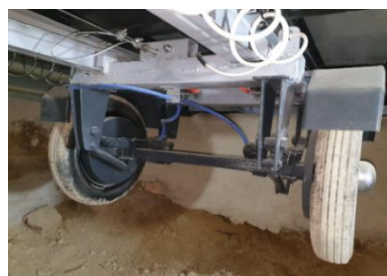
Сурет 4.11 – Қос таврлы балка бойымен қозғалатын алдыңғы және артқы осьтер
