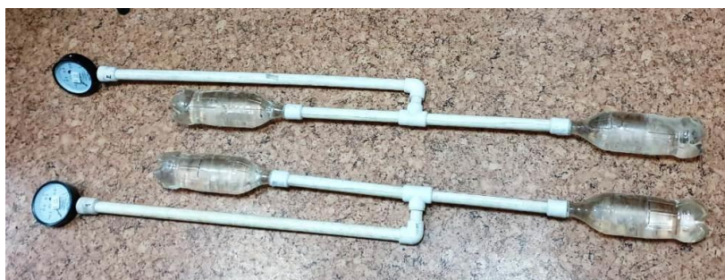
Сурет 4.22 – Жүктемелерді тіркеуге арналған қолдан жасалған өлшеу аспабының конструкциясы
