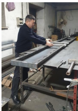
Сурет 4.5 – Жүріс бөлігінің қос таврлы балкаларын дайындау және монтаждау
