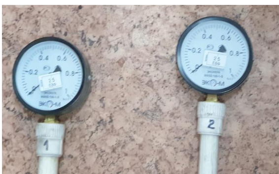
Сурет 4.23 – Эксперименттің бірінші кезеңінде өлшеу аспабының көрінісі (№1 және №2 манометрлер, «ЭКОМЕРА МД02-1001-G» моделі)
