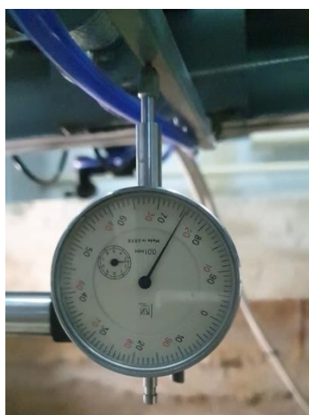
Сурет 4.24 – Осьтерді жылжыту балкасының иілуін өлшеу үшін орнатылған сағаттық типті индикатор
