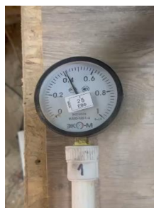
Сурет 4.32 – Мобильді жол өтпесінің жоғарғы платформасына түсетін жүктемелерді тіркеу үшін манометрлердің орналасуы
