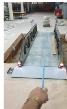
Сурет 4.31 – Арқанның көмегімен оператордың жүктемелік арбаны қолмен жылжытуы
