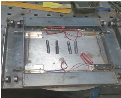
Сурет 4.9 – Мобильді жол өтпесінің жылжымалы кареткаларын бекіту механизмін дайындау
