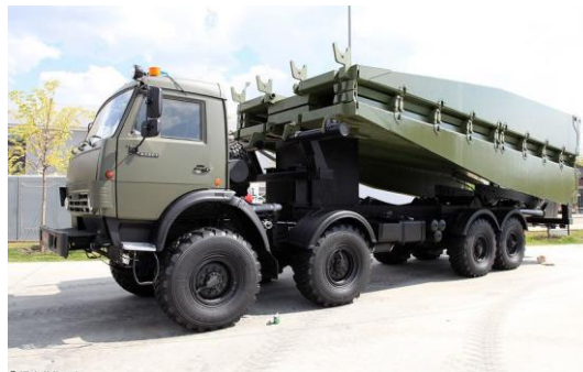
Сурет 1.12 – ТММ-7 «Пролет» ауыр механикаландырылған көпірі (2017ж.)
