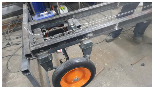
Сурет 4.7 – Жылжымалы каретканың құрастырылған күйдегі конструкциясы (жалпы көрінісі және артқы ось)
