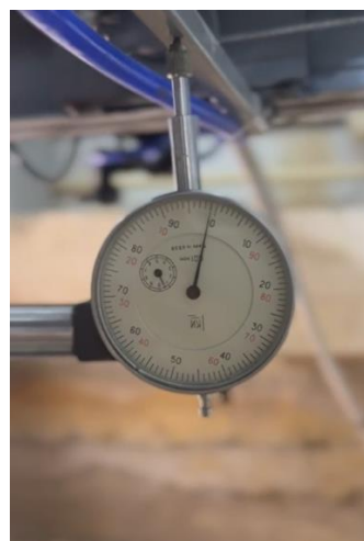
Сурет 4.37 – ИЧ-10 сағаттық типті индикаторды мобильді жол өтпесінің осьтерді жылжыту балкасына орнатылуы
