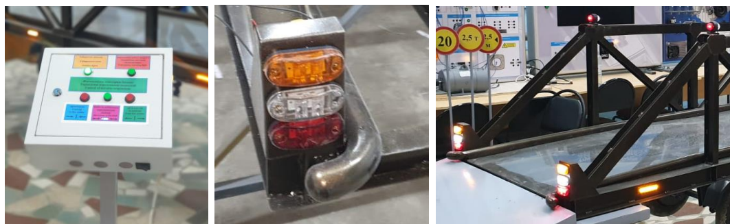
Сурет 4.13 – Эксперименттік стендінің жылжымалы осьін басқару блогы және жарықтық сигнал беру жүйесі
