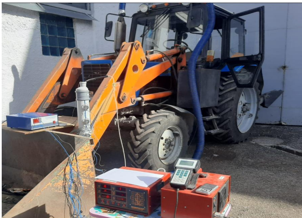
Сурет 3.7 - МТЗ-80 тракторына дизельді қозғалтқыштың ультрадыбыстық сөндіргішін қосу
