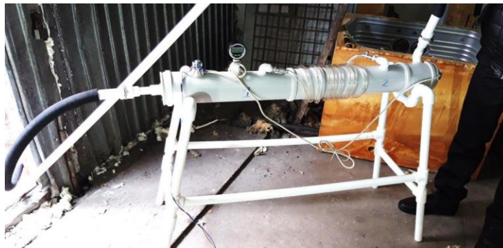
Сурет 2.5 – Эксперименттік полипропиленнен жасалған ультрадыбыстық автомобиль бәсендеткіші
