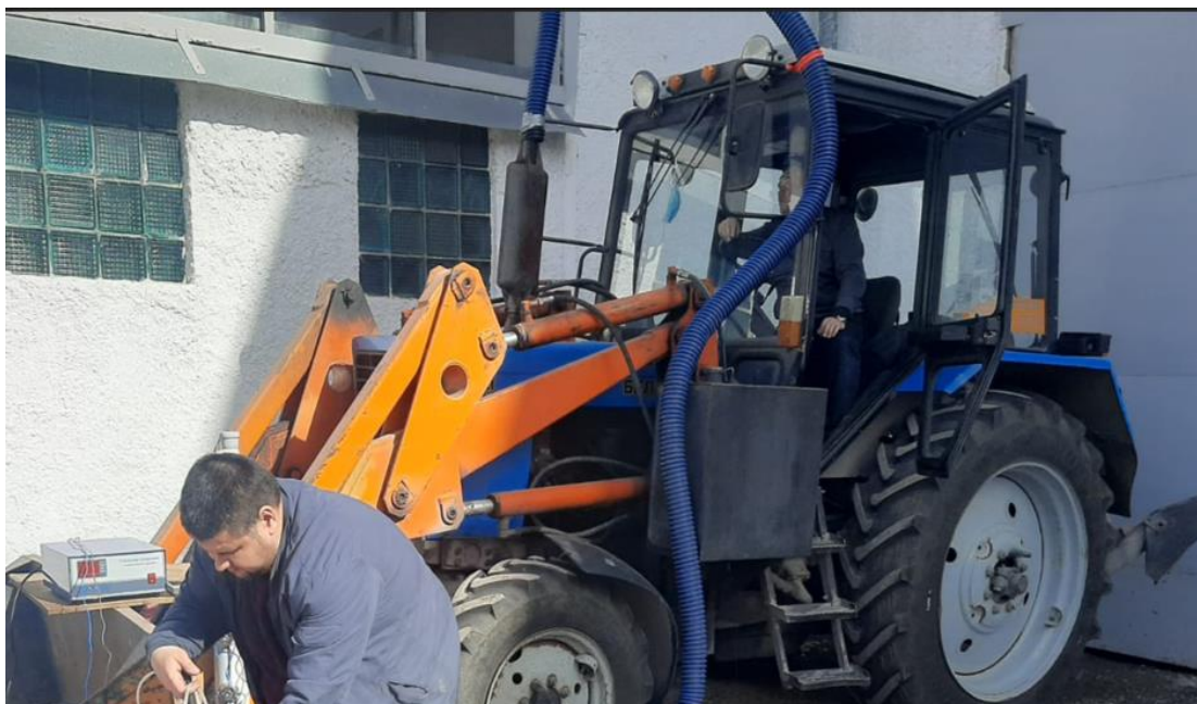
Сурет 3.6 - МТЗ-80 тракторына дизельді қозғалтқыштың ультрадыбыстық бәсендеткішті қосу процесі
