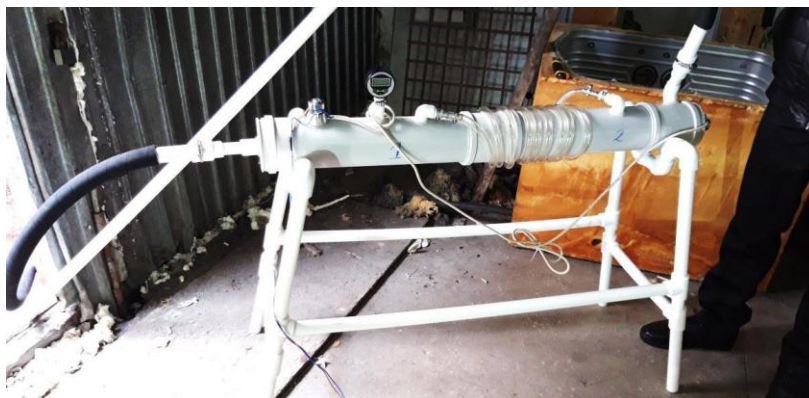
Сурет 2.5 – Эксперименттік полипропиленнен жасалған ультрадыбыстық автомобиль бәсендеткіші
