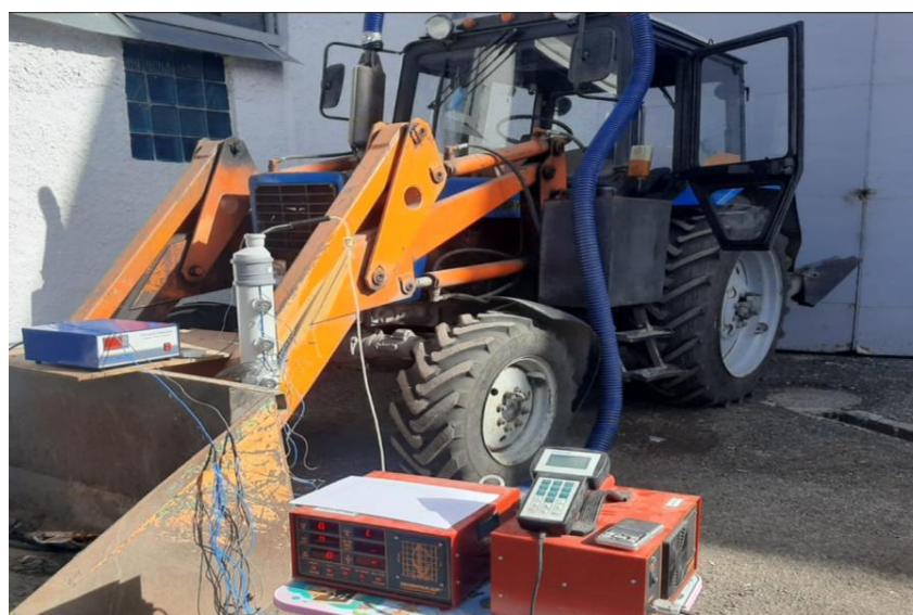
Сурет 3.7 - МТЗ-80 тракторына дизельді қозғалтқыштың ультрадыбыстық сөндіргішін қосу
