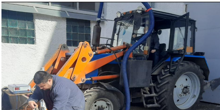
Сурет 3.6 - МТЗ-80 тракторына дизельді қозғалтқыштың ультрадыбыстық бәсендеткішті қосу процесі
