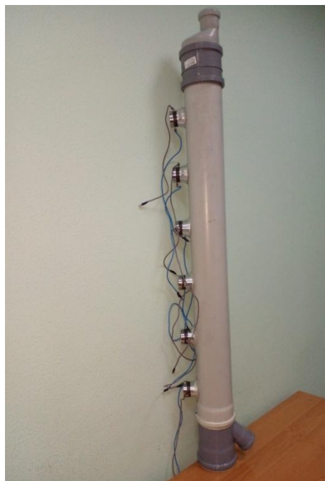
Сурет - 3.1 - Дизельді қозғалтқыштың модульдік ультрадыбыстық бәсендеткіші
