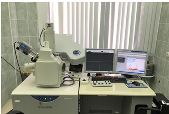
Рисунок 2.8 – Сканирующий электронный микроскоп (SEM) Hitachi S-3400N
