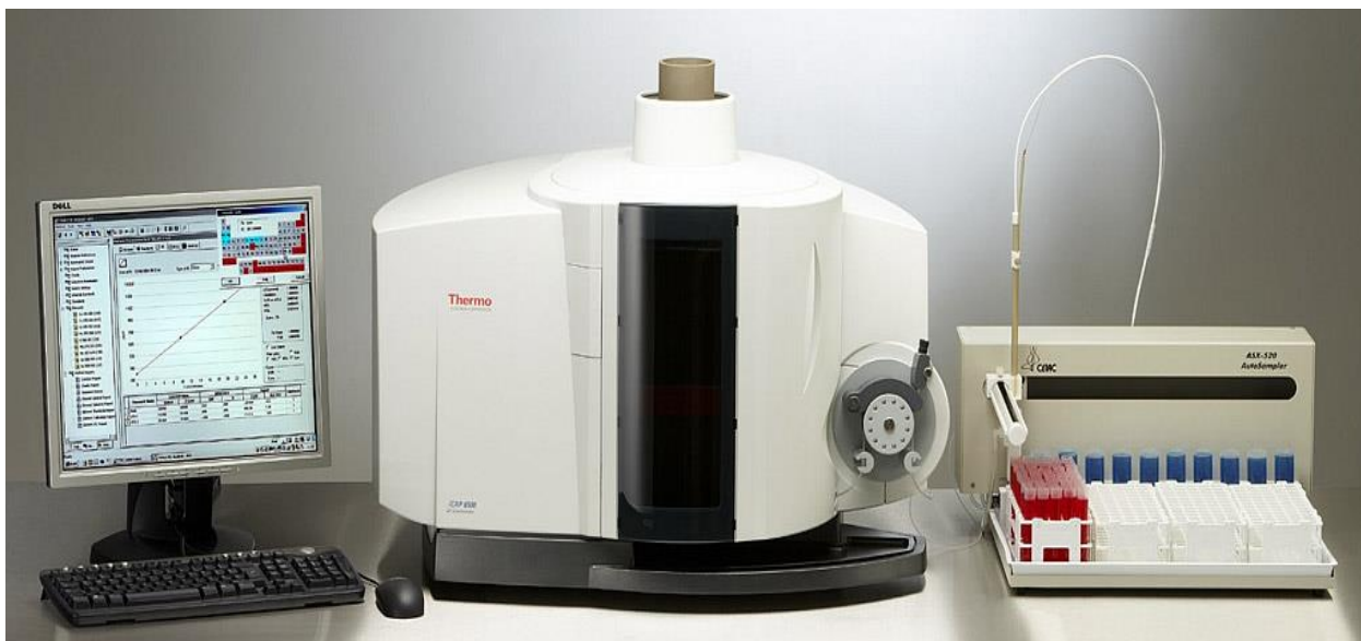
Рисунок 2.5 – Атомно-эмиссионный спектрометр с индуктивно-связанной плазмой iCAP 7600 Duo
