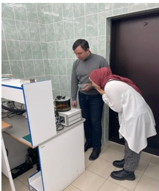
Рисунок 2.7 – Ознакомление с процедурой подготовки образцов для анализа в лаборатории сканирующей электронной микроскопии НИ ТПУ (г. Томск). Процесс вакуумного напыления проводящего слоя на угольные шлифы перед SEM-исследованием. Фото совместно со старшим преподавателем Института природных ресурсов, кандидатом геолого-минералогических наук Ильенко С.С.
