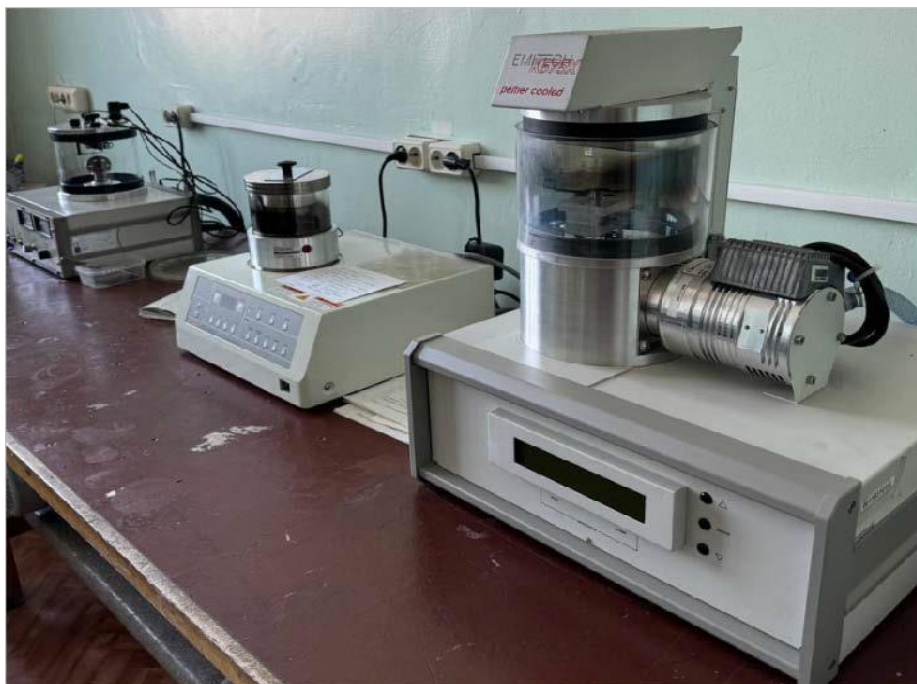
Рисунок 2.9 – Автономные вакуумные системы (посты, распылительные установки) для распыления препаратов с углеродом и/или металлами. Лаборатория микро- и наноисследований ДВГИ ДВО РАН
