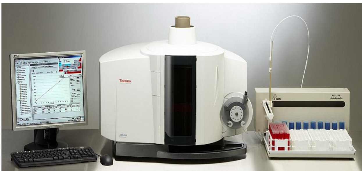
Рисунок 2.5 – Атомно-эмиссионный спектрометр с индуктивно-связанной плазмой iCAP 7600 Duo
