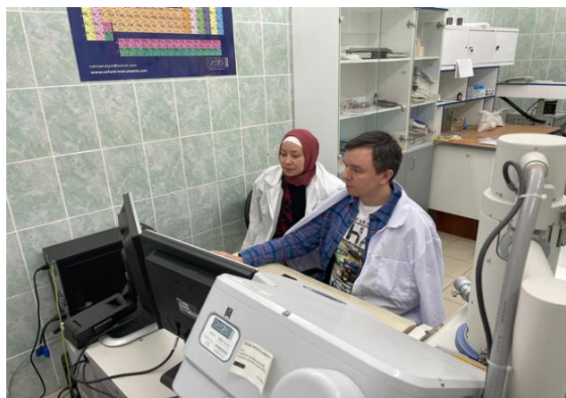
Рисунок 2.8 – Сканирующий электронный микроскоп (SEM) Hitachi S-3400N
