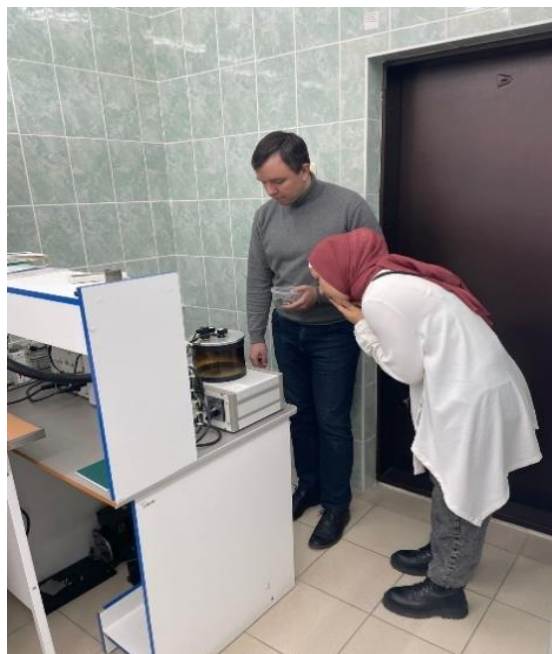
Рисунок 2.7 – Ознакомление с процедурой подготовки образцов для анализа в лаборатории сканирующей электронной микроскопии НИ ТПУ (г. Томск). Процесс вакуумного напыления проводящего слоя на угольные шлифы перед SEM-исследованием. Фото совместно со старшим преподавателем Института природных ресурсов, кандидатом геолого-минералогических наук Ильенко С.С.
