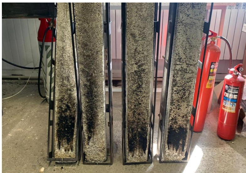
Рисунок 4.12 – Процесс исследования группы горючести ВППБ
