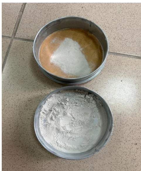
Рисунок 2.7 – Тонкость помола шлака через сито 0,008
