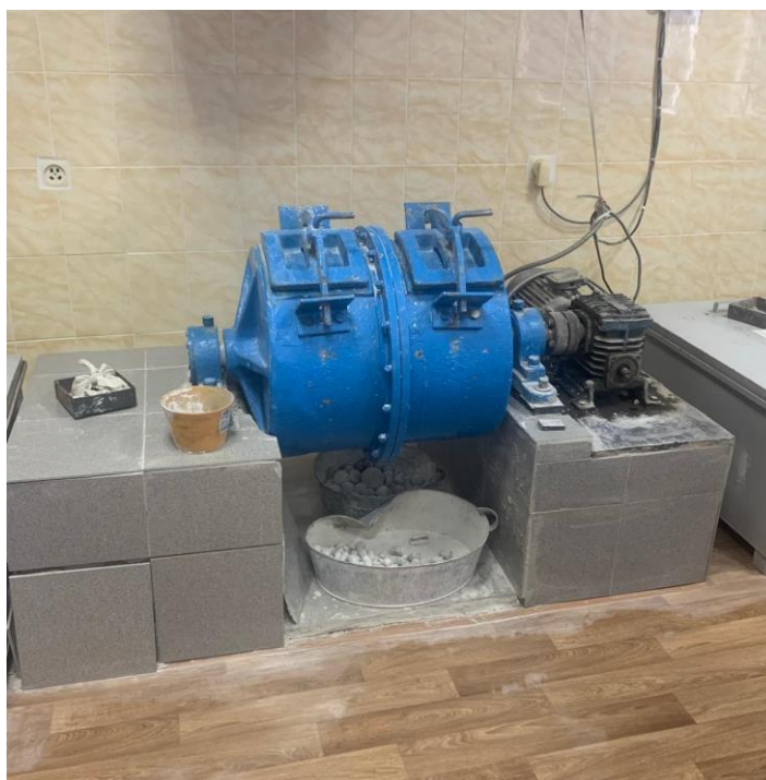
Рисунок 2.6 – Шаровая мельница для измельчения доменного шлака
