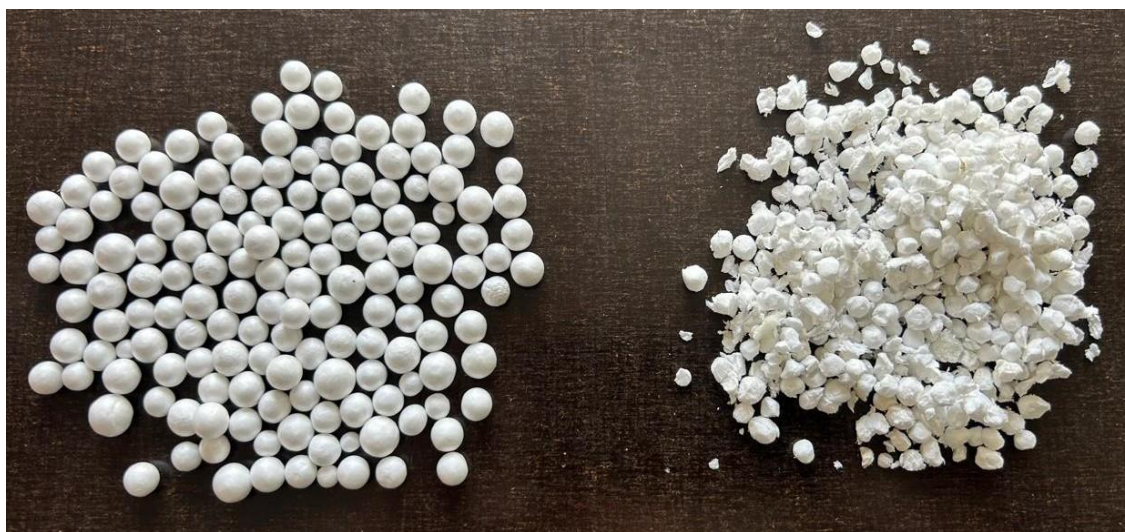
Рисунок 2.9 – Гранулы ППС фракции 5-10 мм (слева), 2,5-5 мм (справа)
