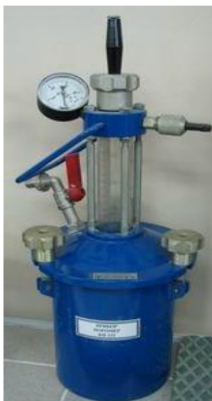
Рисунок 3.7 – Поромер для определения пористости бетонной смеси
