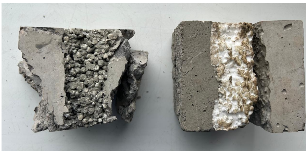
Рисунок 4.8 – Сравнение макетов после испытания нагрузкой со слоем ВППБ и слоем полистирольной плиты
