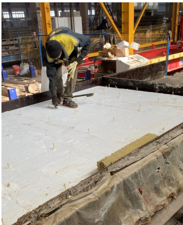
Рисунок 4.3 – Процесс установки связей на полистирольную плиту
