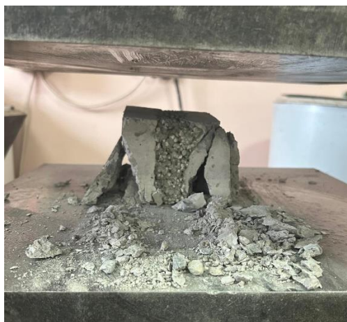
Рисунок 4.7 – Характер разрушения образцов трехслойных стеновых панелей со слоем ВППБ
