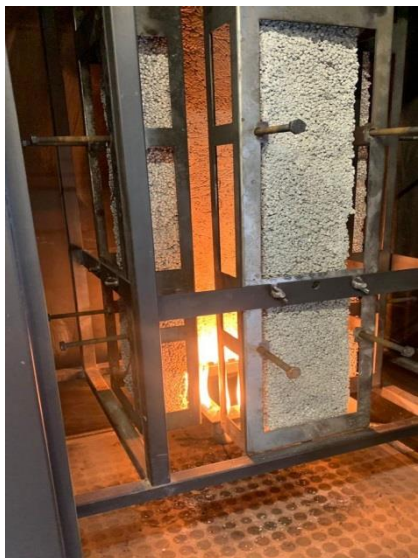
Рисунок 4.12 – Процесс исследования группы горючести ВППБ
