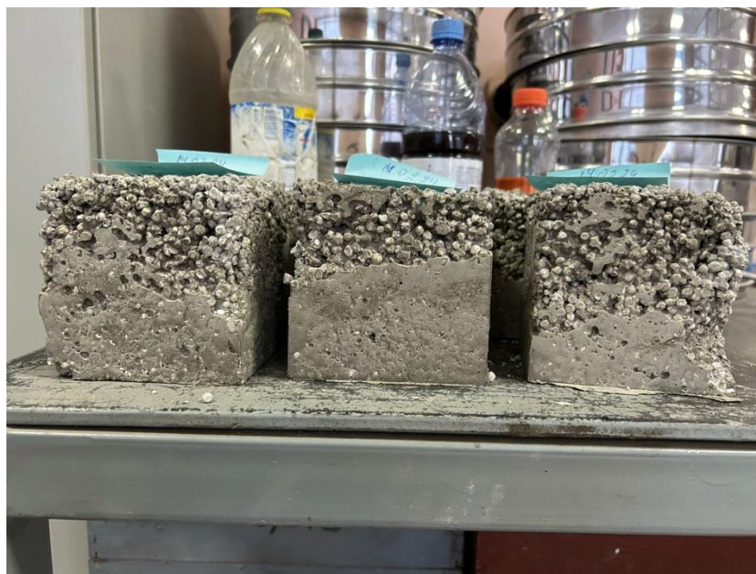
Рисунок 2.11 – Расслоение бетонной смеси при В/В 0,6
