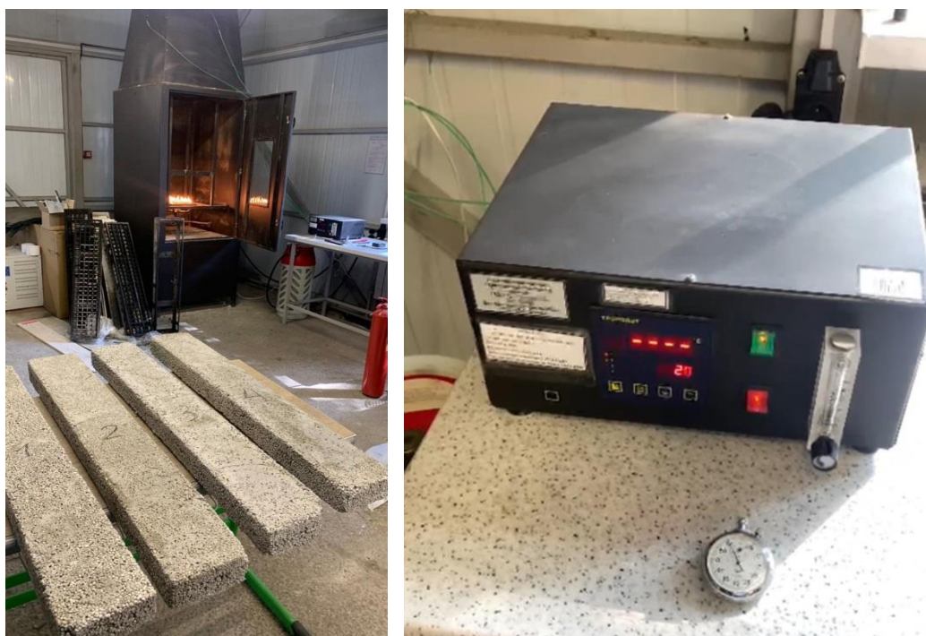
Рисунок 4.11 – Подготовка образцов к определению группы горючести
