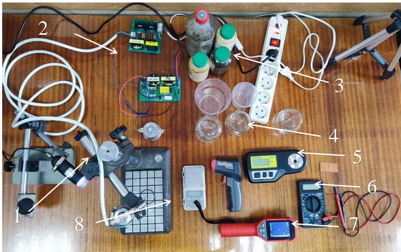
1 – ультразвуковой излучатель, 2 – ультразвуковой генератор, 3 – СОЖ для очистки, 4 – емкости для эксперимента, 5 - рефрактометр, 6 – мультиметр, 7 – тепловизор.
