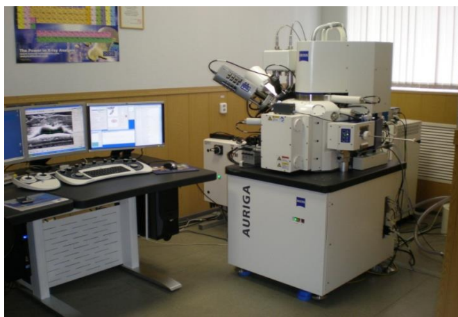
2.6 сурет – Микроанализ жүйесі және EBSD бар AURIGA екі бағанды растрлық микроскоп
