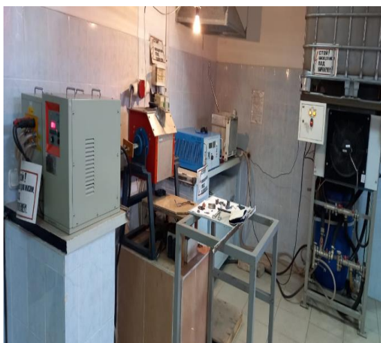
2.2 сурет – УИП-25 маркалы балқыту құрылғысы.
