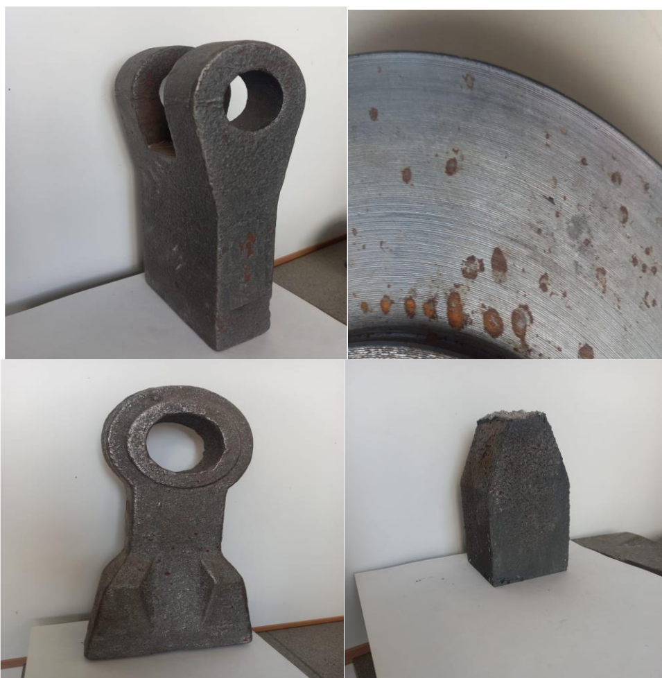
4.7 сурет – Питтинг дақтарымен зақымданған құймалар беттері
