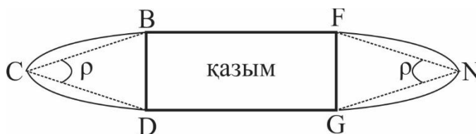
2-сурет. Қазымның бүйір жақтарындағы таужыныстардың бұзылуының шегі
