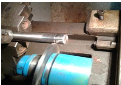
4 – сурет - ИЧ300Х18Г3 тозуға төзімді шойынды ротациялық-фрикциялық жону процесі
