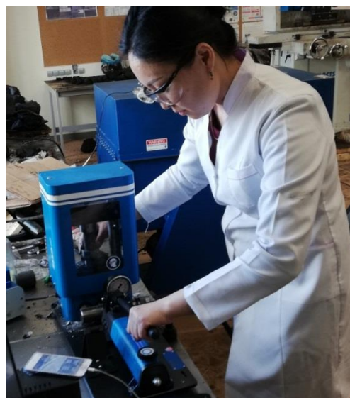
Рисунок 2. Установка образца под прессом PLT-2W для определения прочности его при одноосном сжатии
