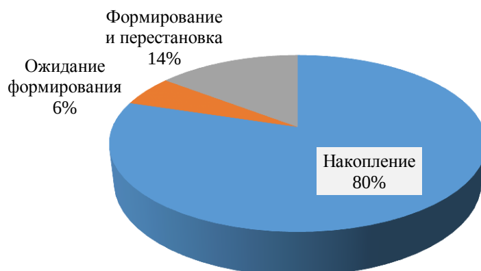
Рис. 1. Структура среднесуточные долю времени нахождения транзитного вагона в сортировочном парке
