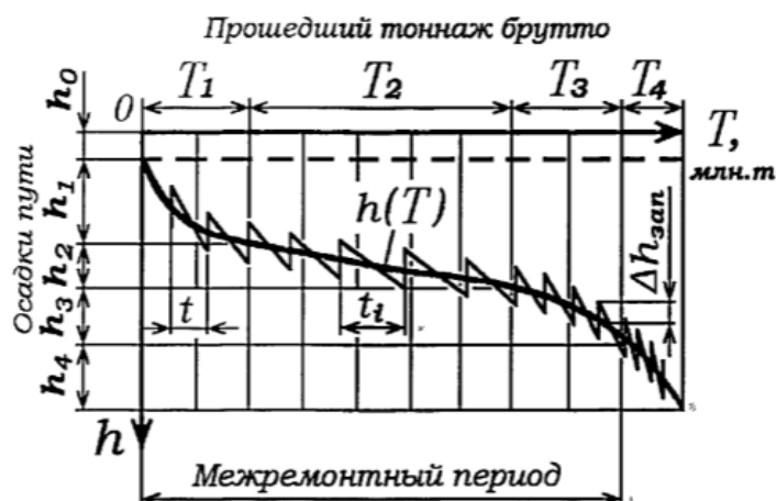
Рис. 1.1. График накопления остаточных осадок пути h в зависимости от пропущенного тоннажа брутто T , где T_1 — период стабилизации; T_2 — период нормальной эксплуатации; T_3 — период критической эксплуатации; T_4 — аварийный период; t — периоды между выправками пути; \Delta h_{\text{зап}} — запас на осадку
