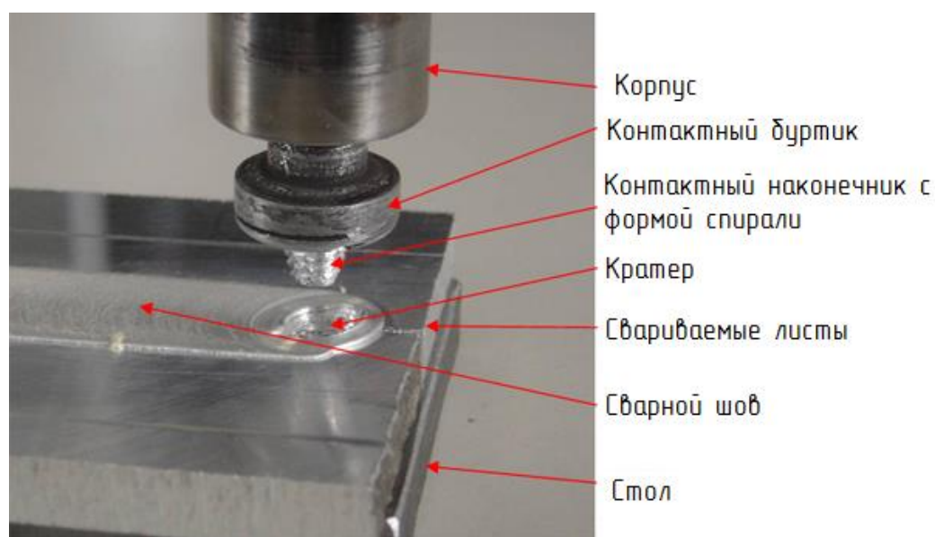
Рисунок 1– Инструмент для сварки трением с перемешиванием
