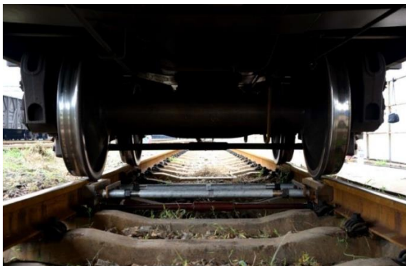
Сурет 2 – Промвес 30 вагондық таразының жұмыстағы көрінісі
