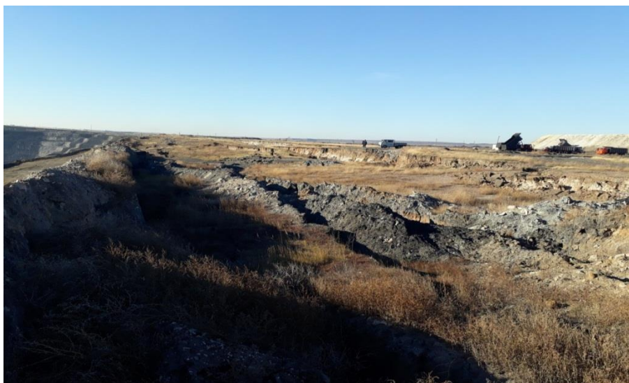
1-сурет. Тілік жағдауы тұрақтылығының бұзылуы салдарынан жарықшақтардың пайда болуы
