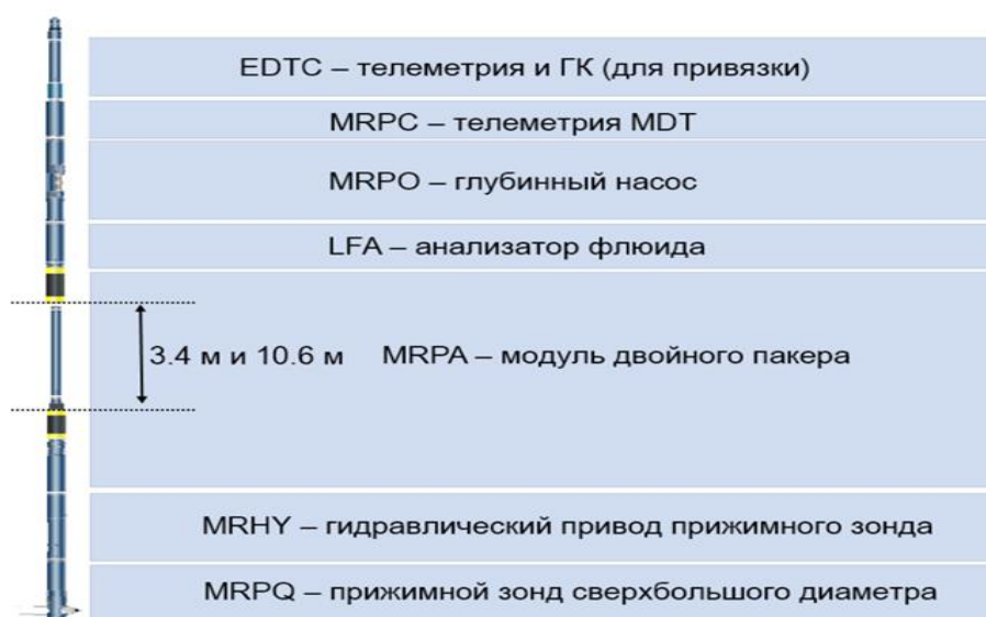
Рисунок 1 – Конфигурация прибора MDT (первый спуск с межпакерным интервалом 10,6 м, второй спуск с 3,4 м)
