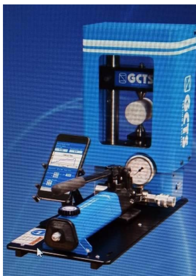
Рисунок 1. Прибор для испытания на точечную нагрузку PLT-2W
