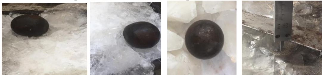
Рисунок 2 – Разрушение льда сферическими бойками
