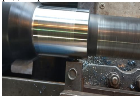
Рис.1. Обточка вала Ø 57мм из стали марки 12ХН3А
