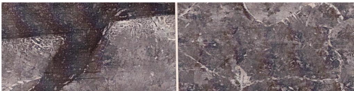
Рисунок 2 - Микроструктуры в области дефекта заготовок
