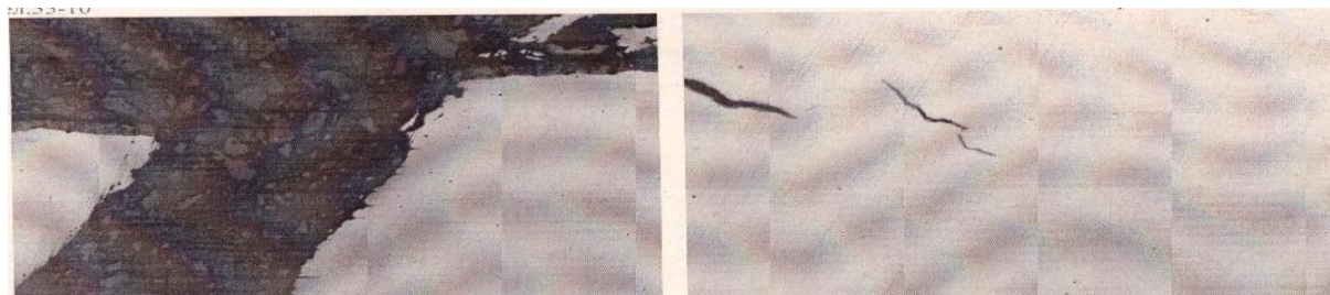
Рисунок 1 – Макроструктура в области дефекта заготовок
