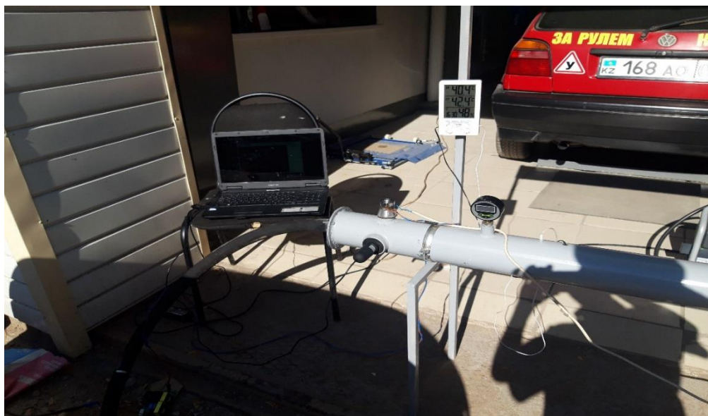
Рисунок 1 – Экспериментальный металлический ультразвуковой автомобильный глушитель
