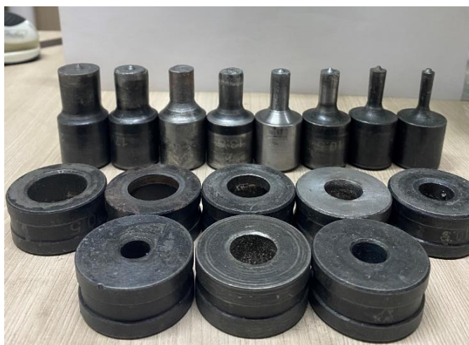
1-сурет – Адгезиялық тозуға ұшыраған шинатескіш құралдар мен әбзелдер
