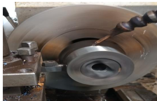
Рис.2. Обточка вала Ø 100 мм из стали марки 5ХНМ
