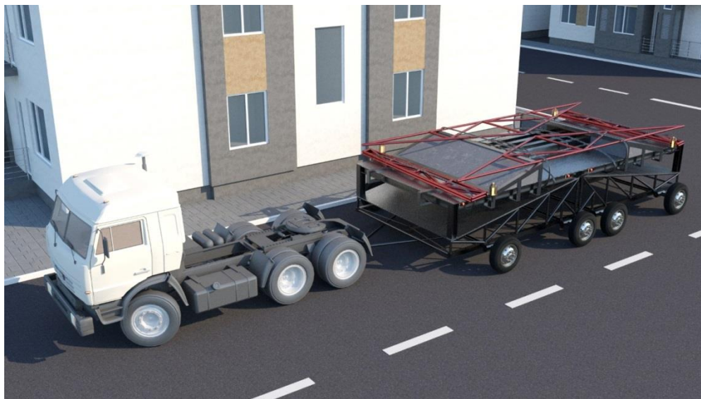
Рисунок 1 – Модульный мобильный путепровод в транспортном положении
