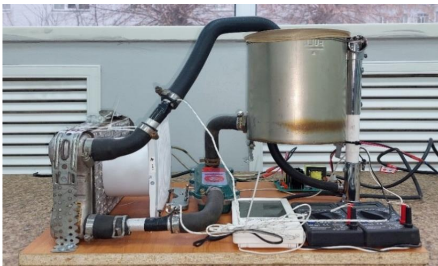
Рисунок 1 – Экспериментальный стенд для ультразвуковой очистки автомобильных радиаторов.
