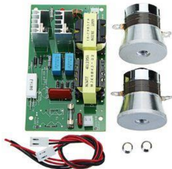
Рисунок 2 - Ультразвуковой генератор с излучателями ультразвуковых волн
