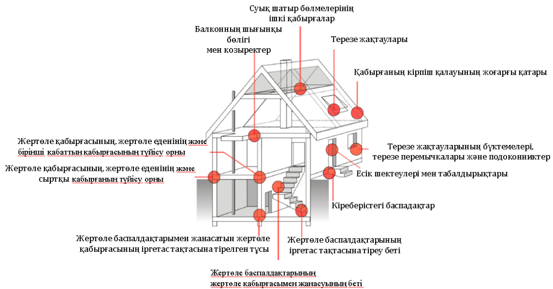
Сурет 1 - "Суық көпірлер" пайда болатын учаскелердің схемасы
