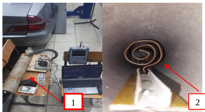
1 – сурет – Толық өлшемді электроимпульстық бәсеңдеткіш: 1-бәсеңдеткіштің корпусы; 2-корпустың ішіне орнатылған электродтар
