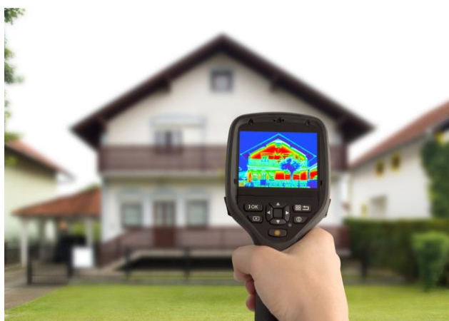
Рисунок 1 - Проведение энергоаудита частного жилого дома
