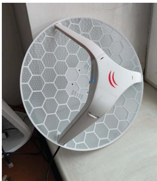
1 сурет – а) Спектралды анализатор құрылғысы ә) Сымсыз байланысқа арналған бағытталған MikroTik RBLHGG-60ad антенналары
