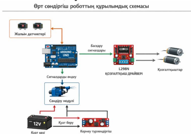
Сурет 1 – Өрт сөндіргіш роботтың құрылымдық схемасы
