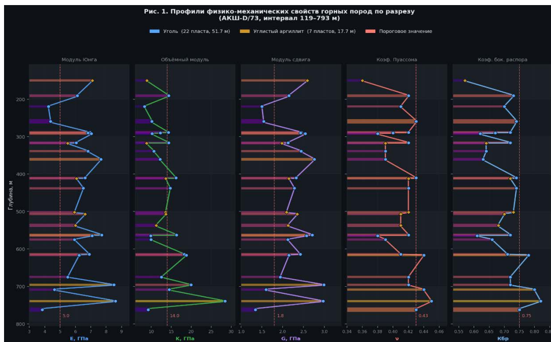
Рисунок. 1. Физико-механические свойства угленосного разреза: (верхний ряд) вертикальные профили E , K , G , \nu , K_{br} по глубине; (нижний ряд) кросс-плоты E vs \nu и G vs K , профиль K_{br} , ящичные диаграммы E , гистограмма G . Синие точки - уголь, коричневые - углистый аргиллит.
