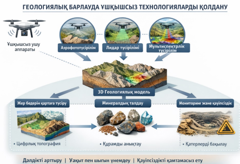
Сурет 1 – Геологиялық барлауда ұшқышсыз ұшу аппараттарын қолдану схемасы
