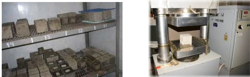
Рисунок 2 - Образцы бетона с использованием микросилики ТОО «Tau-Ken Temir» и процесс определения их прочности
