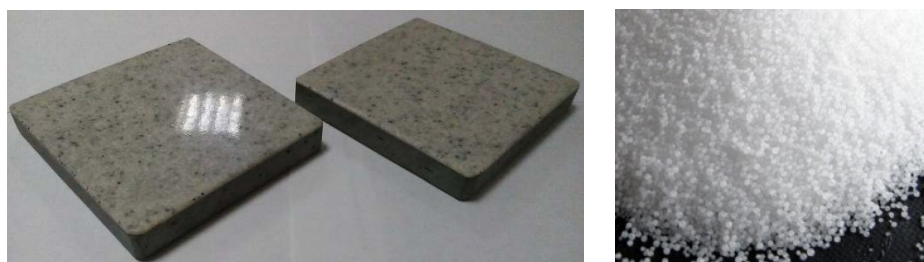
Рисунок 3 - Образцы опытной партии облицовочной плитки и СКЖС из микросилики ТОО «Tau-Ken Temir»
