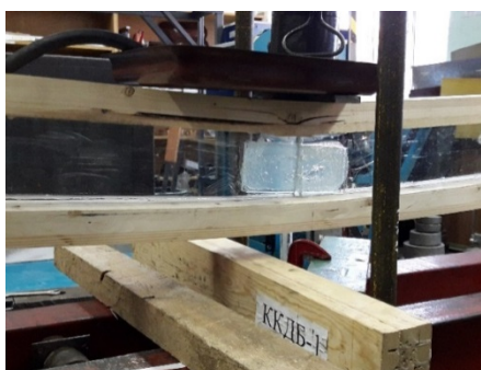
Рисунок 2 – Опытная балка при разрушении
