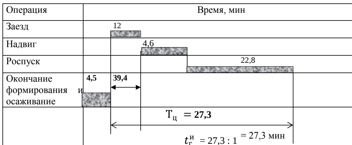
Рисунок 2 – Технологический график работы горки с КГМ
