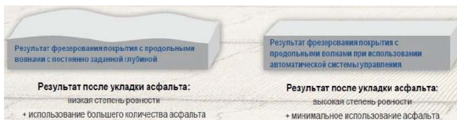
Результат фрезерования машин с 2D и 3D САУ
