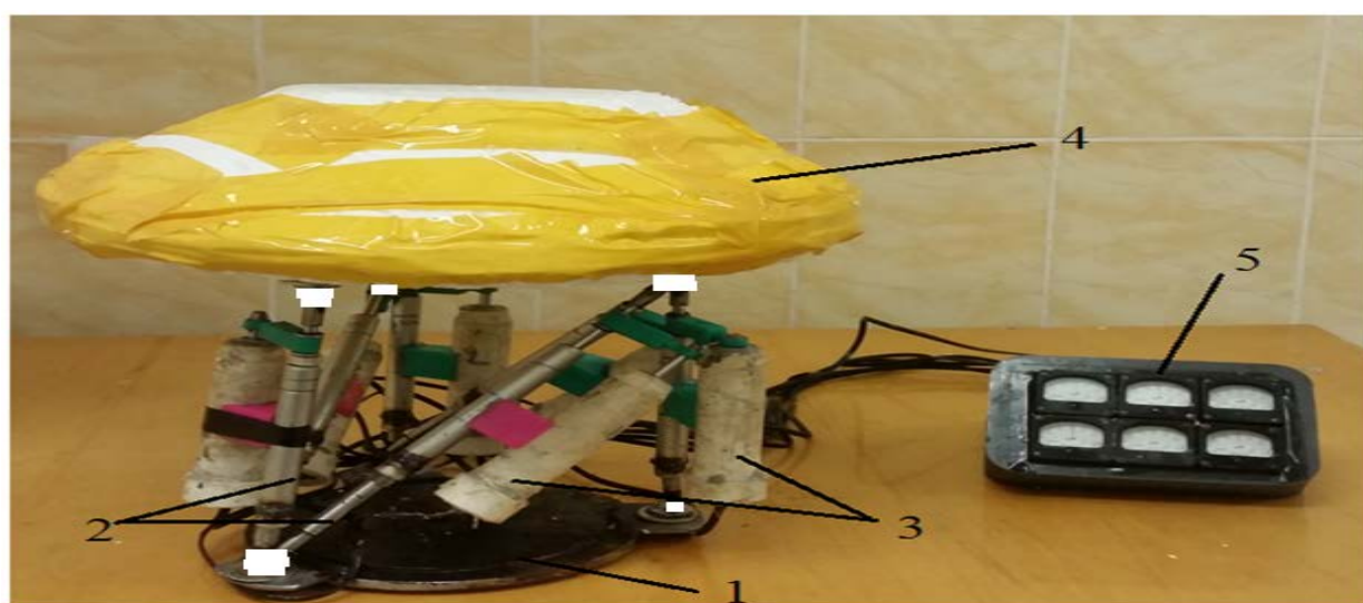
Рис.1. Действующая лабораторная модель волновой электростанции
