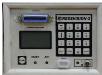
Рисунок 1 – Сканер механических напряжений “STRESSVISION” модели “EXPERT”
