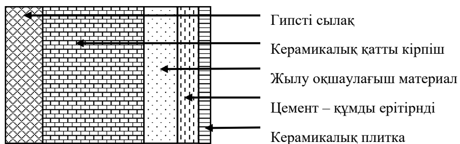
1-сурет. Қабырға құрылымының қабаттарының жалпы тізбегінде жылу оқшаулағыш материалды орналастырудың ең қолайлы нұсқасы
