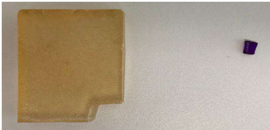
Рис.1 Гидрогель с термочувствительным пигментом: до воздействия повышенной температуры (слева); после воздействия повышенной температуры (справа)
