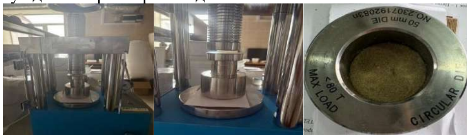
3-сурет. РП-50 сериялы зертханалық гидравликалық пресс
