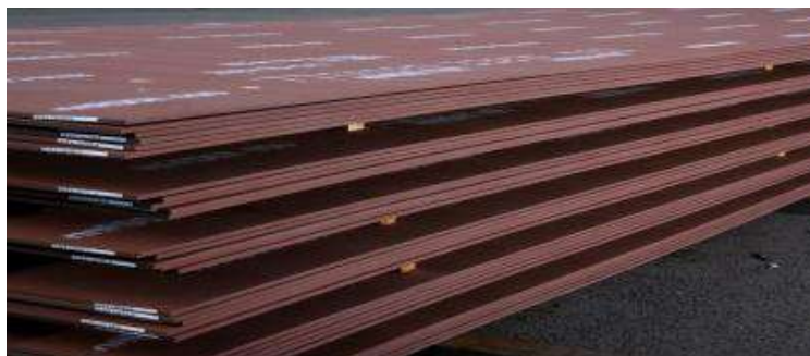
1-сурет - HARDOX 400 болатынан жасалған табақша пішіндес дайындамалар
