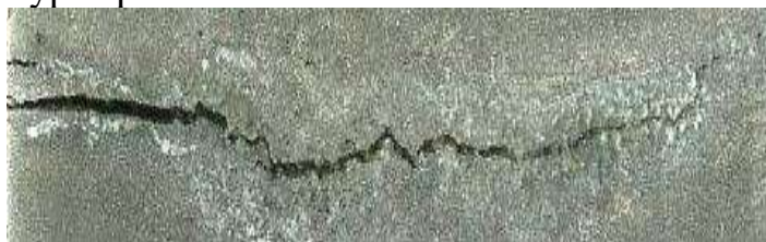
Рисунок 2 – Горячая трещина в аустенитной нержавеющей стали, причина образования трещины – остаточный феррит (светлые участки)
