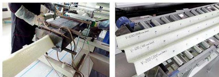
Рисунок 2 — Технологические процессы производства полимерных композитов для мостостроения: схема вакуумной инфузии и пултрузии
