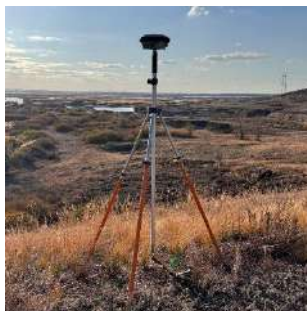
Рисунок 2 - GNSS наблюдения на точке
