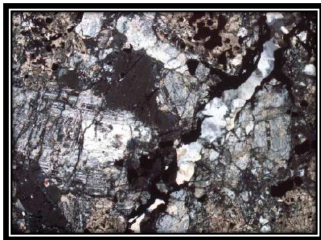
Рисунок 1 – Шлиф № BSH27, гл.43,0 м. Габбродиорит. Увеличение 50 (никколи скрещены)
