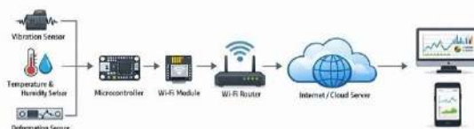
Сурет 1 - Wi-Fi технологиясы негізіндегі құрылыс нысандарының техникалық жағдайын қашықтан мониторингтеу жүйесінің архитектурасы
