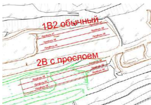
Рисунок 1. – План участков №2 2В с прослоями и №3 1В2 «Центр» с положением профилей электротомографии. Масштаб 1:1000
