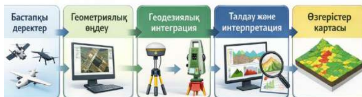
1-сурет - Жер ресурстарының жай-күйінің мониторингі кезінде аэроғарыштық деректерді геодезиялық интерпретациялаудың әдістемелік сызбасы
