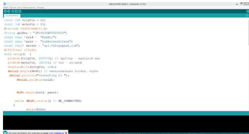
Рисунок 1– Часть программного скетча для передачи данных с датчика расстояния по Wi-Fi модулю и настройка платы для подключения к серверу
