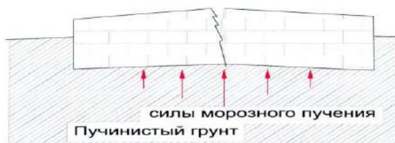
Рисунок 6-предполагаемые силы воздействия морозного пучения
