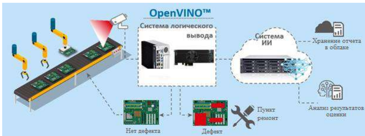
Рисунок 1 – Система автоматического контроля дефектов
