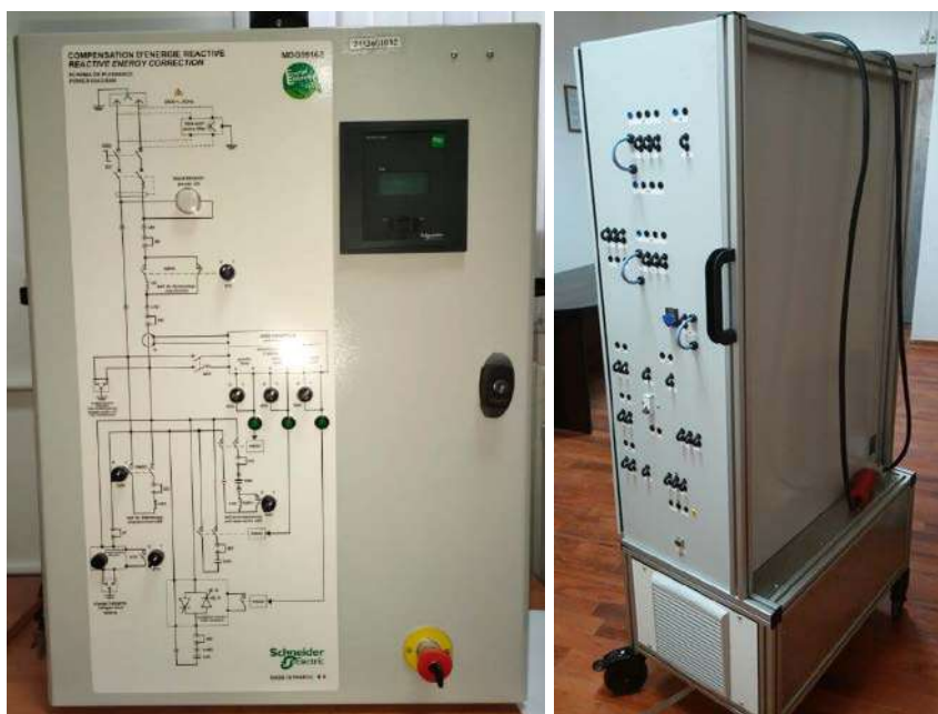
Рисунок 2 - Лабораторное оборудование Schneider Electric: «Компенсация реактивной мощности»
