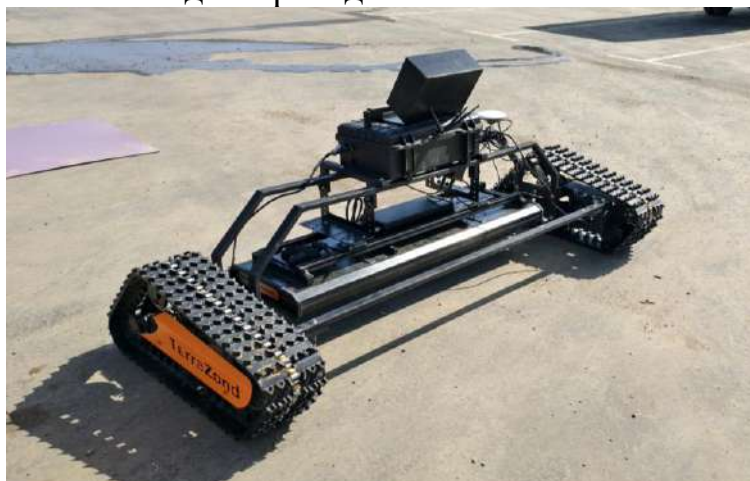
Рис 1. Аппаратура ГРТ-32160 установленная на автономной гусеничной платформе.
