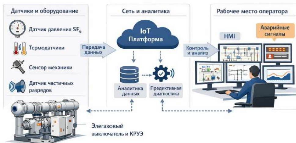
Рис.1 – IoT мониторинг элегазовых выключателей и КРУЭ
