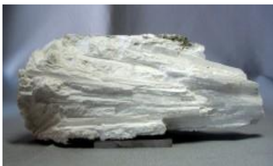
Рисунок 11 а) б) Волластонит и его микроструктура
