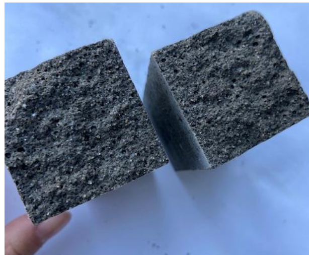
Рисунок 16, 17 – Скол цементных балок с добавкой и без добавки
