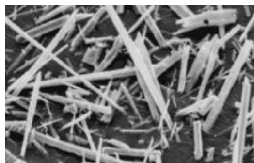
Рисунок 11 а) б) Волластонит и его микроструктура
