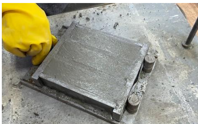
Рисунок 14 – Процесс виброобработки образцов цементных балочек
