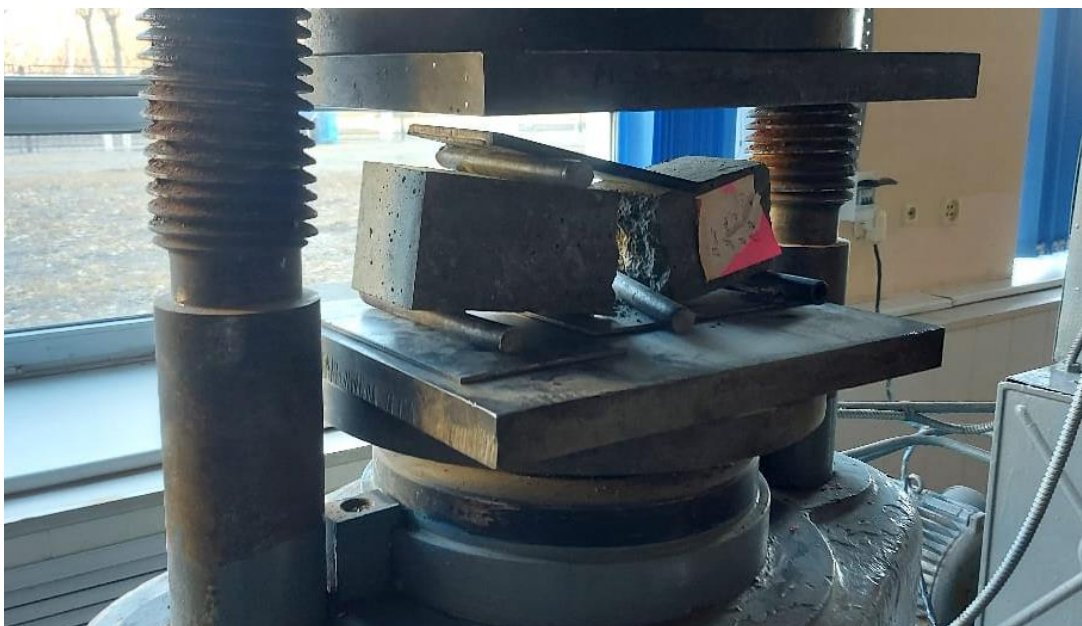
Рисунок 34 – Нагружение образца до разрушения
