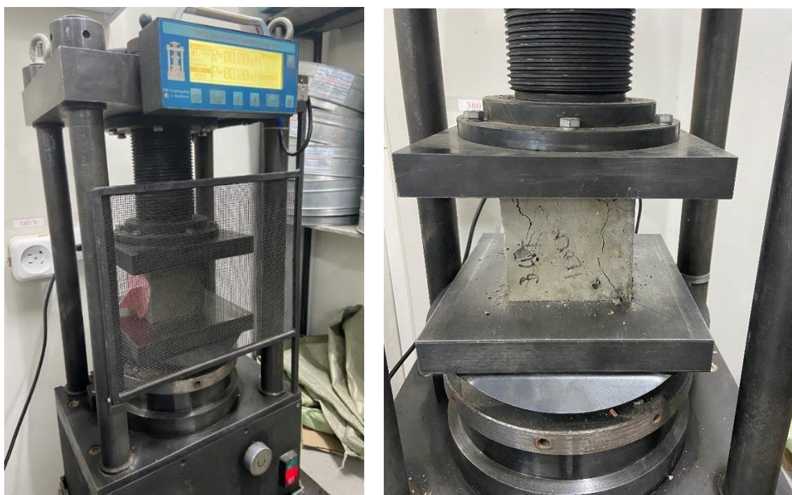
Рисунок 29 - Процесс проведения испытаний кубов на прочность при сжатии и характер разрушения
