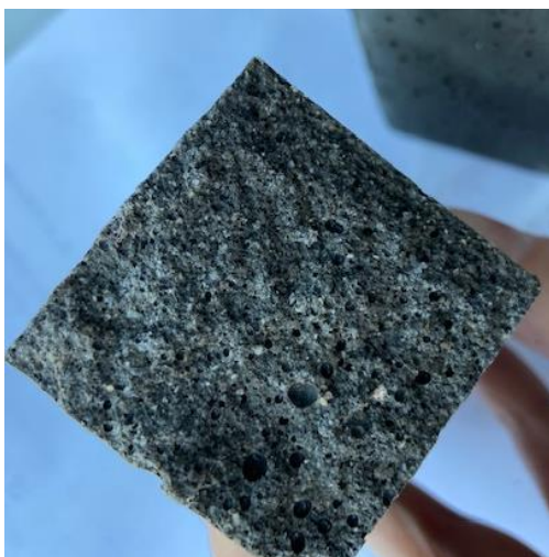
Рисунок 16, 17 – Скол цементных балок с добавкой и без добавки
