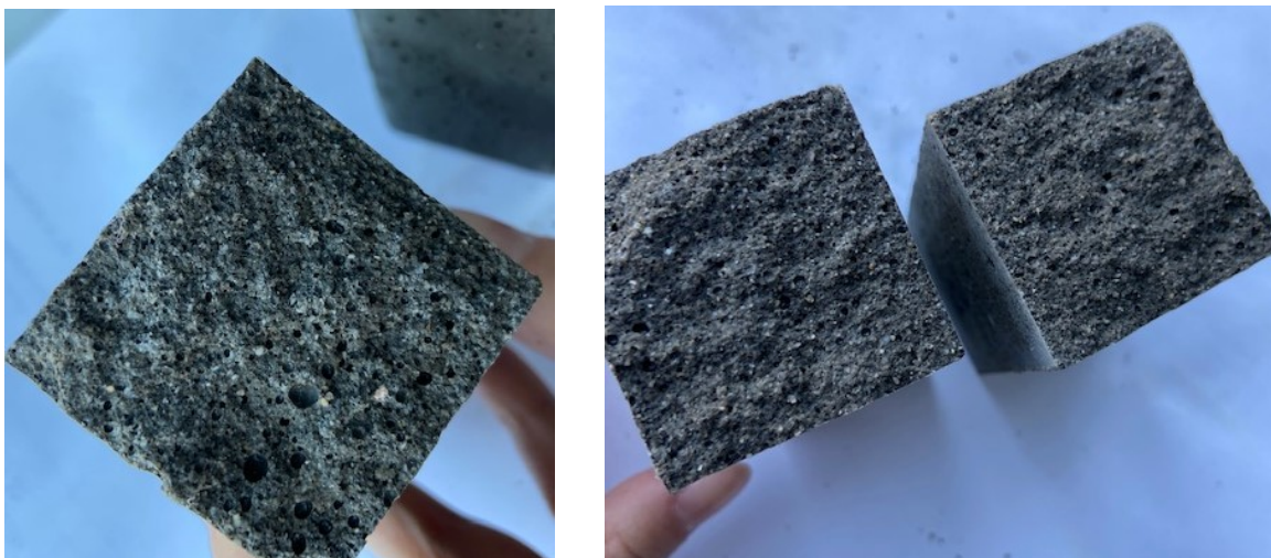
Рисунок 19, 20 – Скол цементных балочек с добавкой и без добавки
