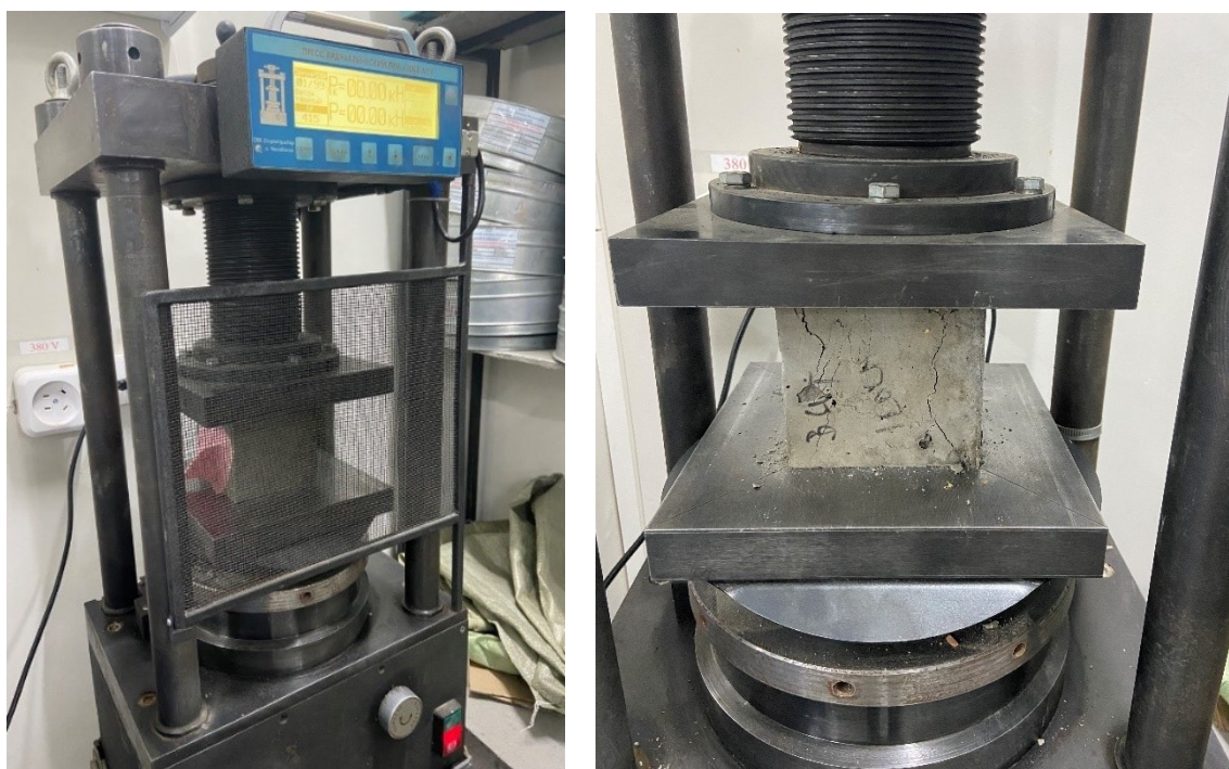
Рисунок 32, 33 - Процесс проведения испытаний кубов на прочность при сжатии и характер разрушения
