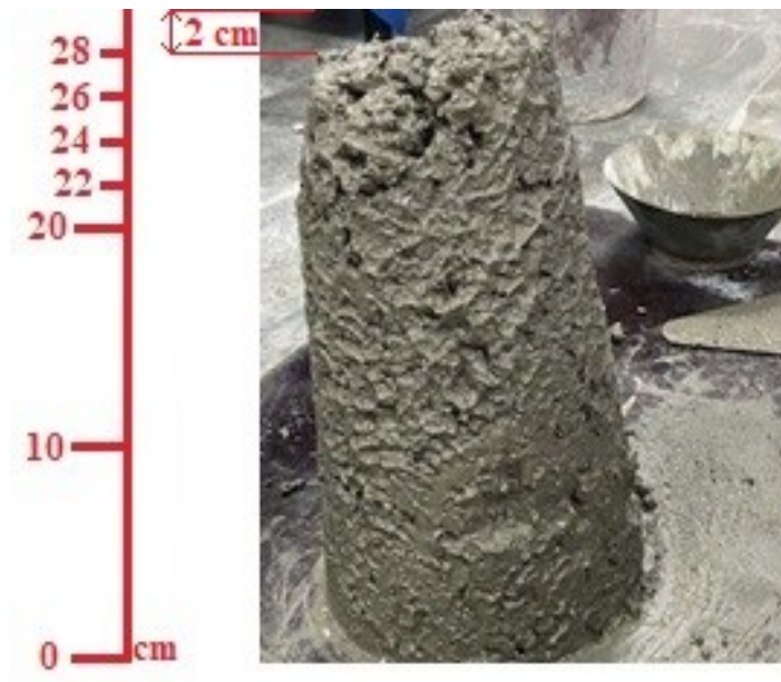
Рисунок 27 - Измерение подвижности бетонной смеси
