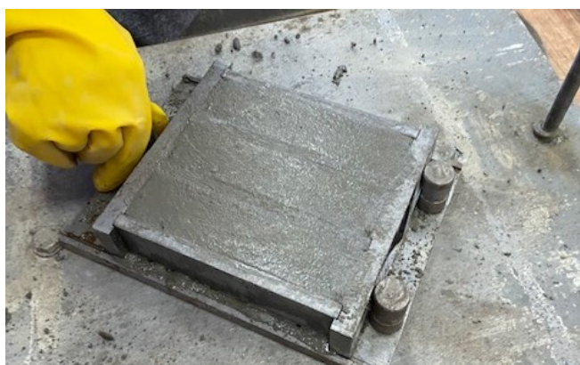
Рисунок 17 – Процесс виброобработки образцов цементных балочек
