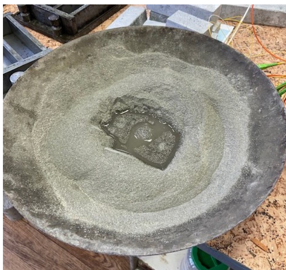
Рисунок 15 – Процесс приготовления цементного теста.
