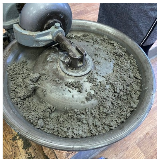
Рисунок 15 – Процесс приготовления цементного теста.
