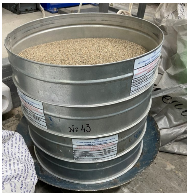
Рисунок 4 - Процесс просеивания песка через набор сит
