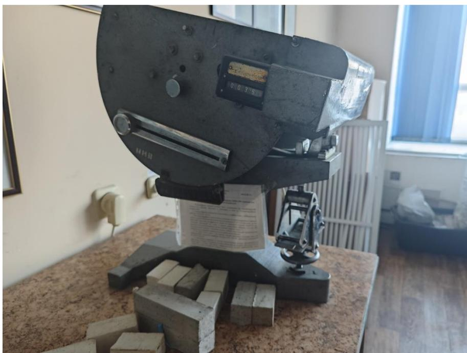
Рисунок 4.7 – Нагружение образца-призмы в лабораторных условиях до момента разрушения
