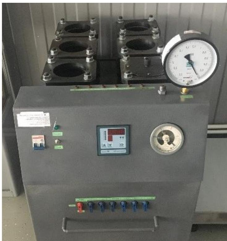
Рисунок 2.17 – Установка УВФ-6/04 для определения водонепроницаемости материала
