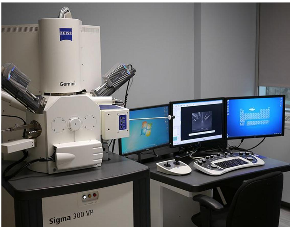
Рисунок 2.14 – Сканирующий электронный микроскоп
