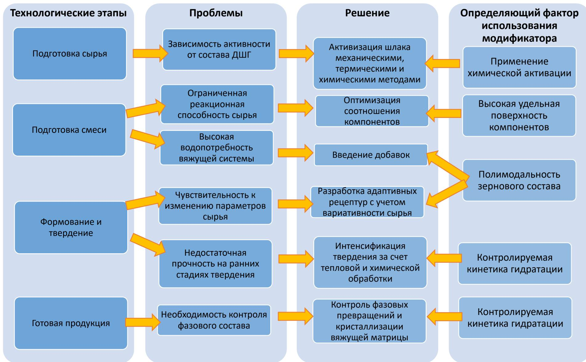
Рисунок 2.10 – Проблемы и способы повышения эффективности производства БВ и бетонов на их основе
