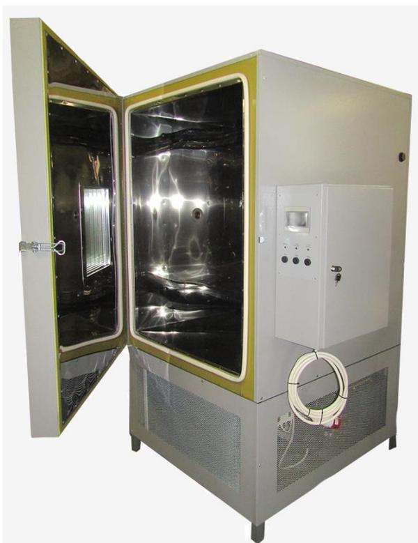
Рисунок 2.18 - Климатическая испытательная камера Тепло-Влага-Холод М-60/100-1000 КТВХ.
