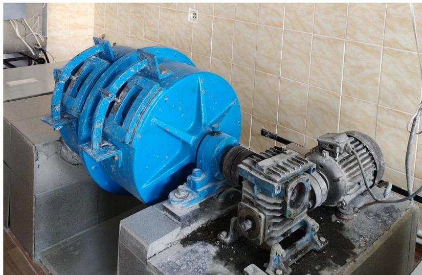
Рисунок 3.1 – Шаровая барабанная мельница
