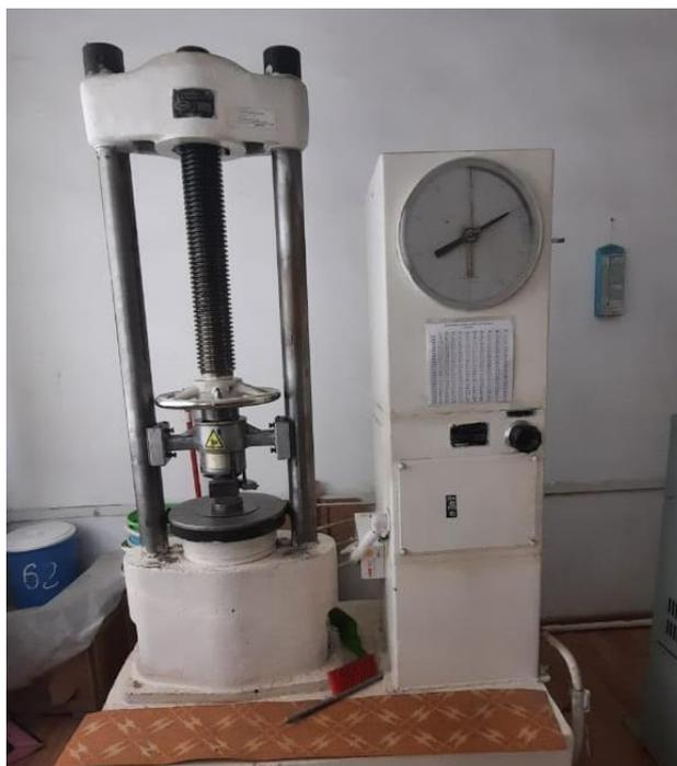
Рисунок 2.15 — Испытательный пресс, применяемый для определения прочностных характеристик
