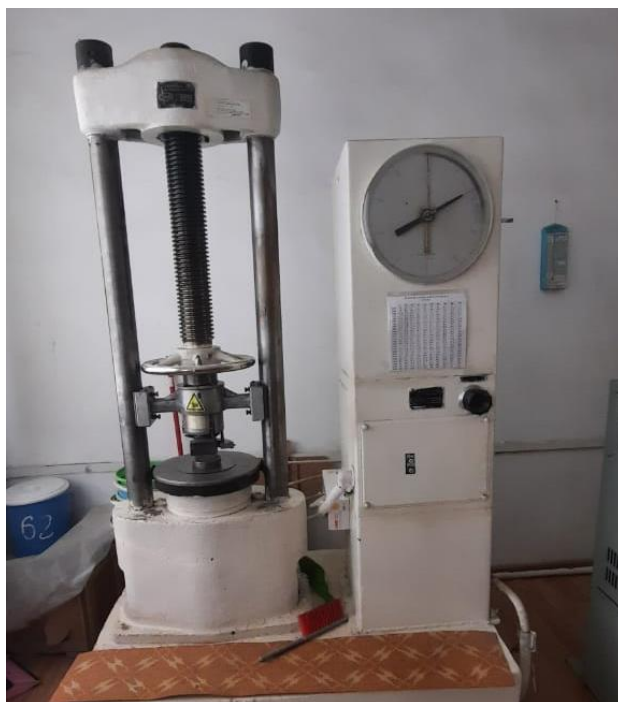
Рисунок 2.15 — Испытательный пресс, применяемый для определения прочностных характеристик
