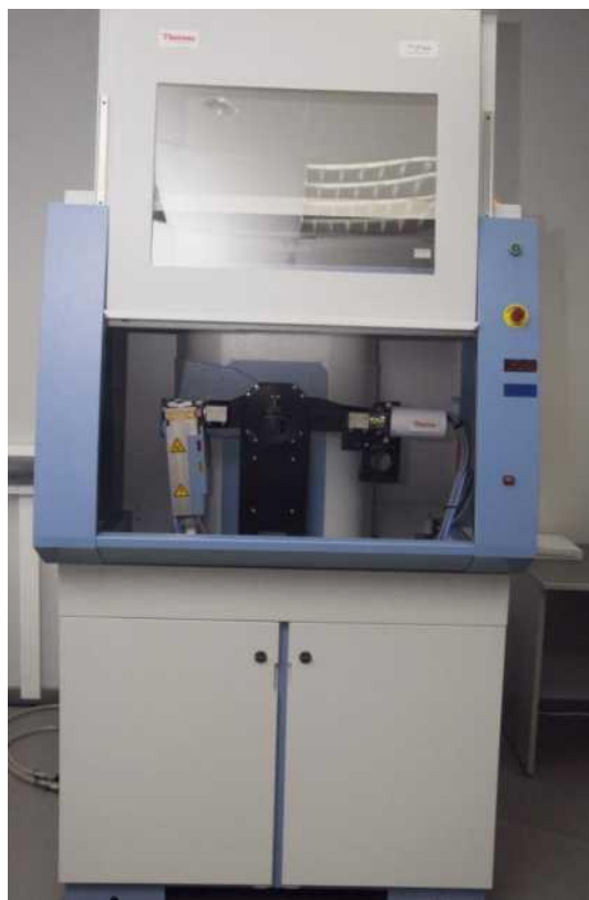
Рисунок 2.13 – Рентгеновский дифрактометр ARL X'TRA
