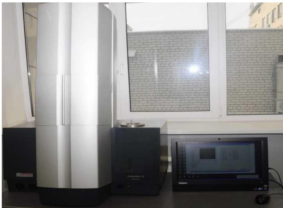
Рисунок 2.11 – лазерный анализатор размера частиц «ANALYSETTE 22» модели Nano Tec
