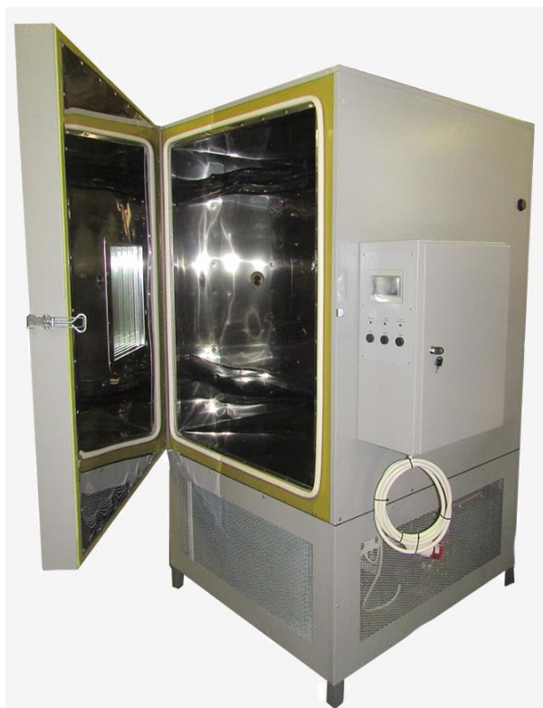
Рисунок 2.18 - Климатическая испытательная камера Тепло-Влага-Холод М-60/100-1000 КТВХ.
