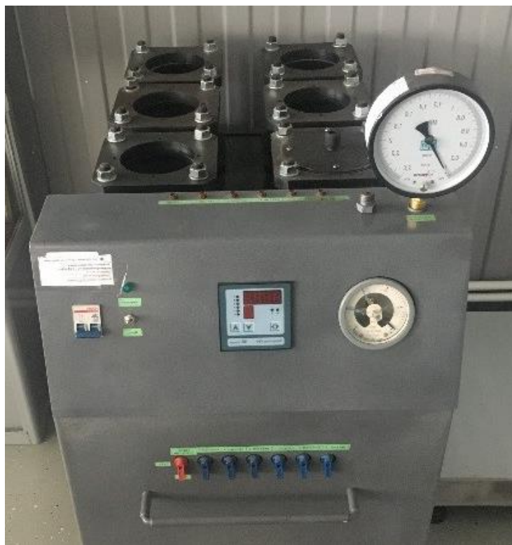
Рисунок 2.17 – Установка УВФ-6/04 для определения водонепроницаемости материала
