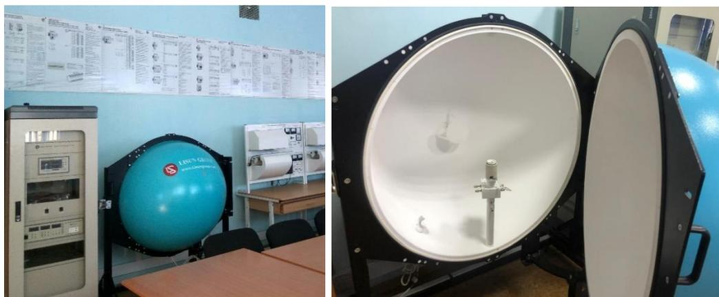
Рисунок 1.4 - Фотометрический шар
