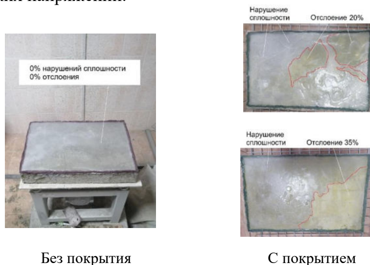
Рис. 1 Образцы, после моделирования термического напряжения
