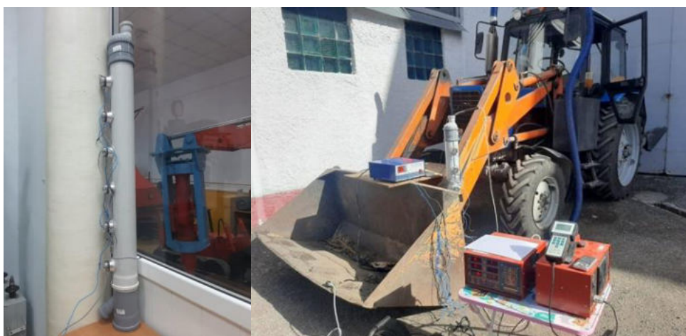
Сурет 1 –МТЗ-80 тракторына дизельді қозғалтқыштың ультрадыбыстық бәсендеткішін қосу
