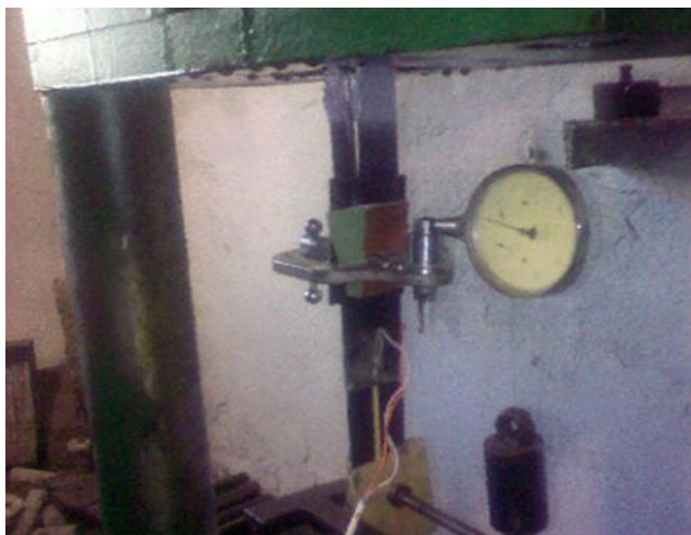
Рисунок 2 - Испытание образца ламината S&P S&H Laminate CFR 150/200
