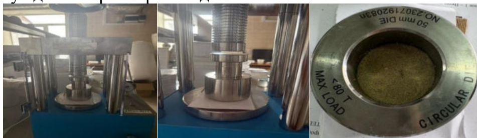
3-сурет. РП-50 сериялы зертханалық гидравликалық пресс
