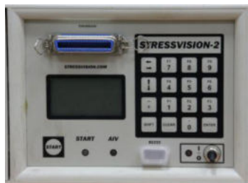
Рисунок 1 – Сканер механических напряжений “STRESSVISION” модели “EXPERT”
