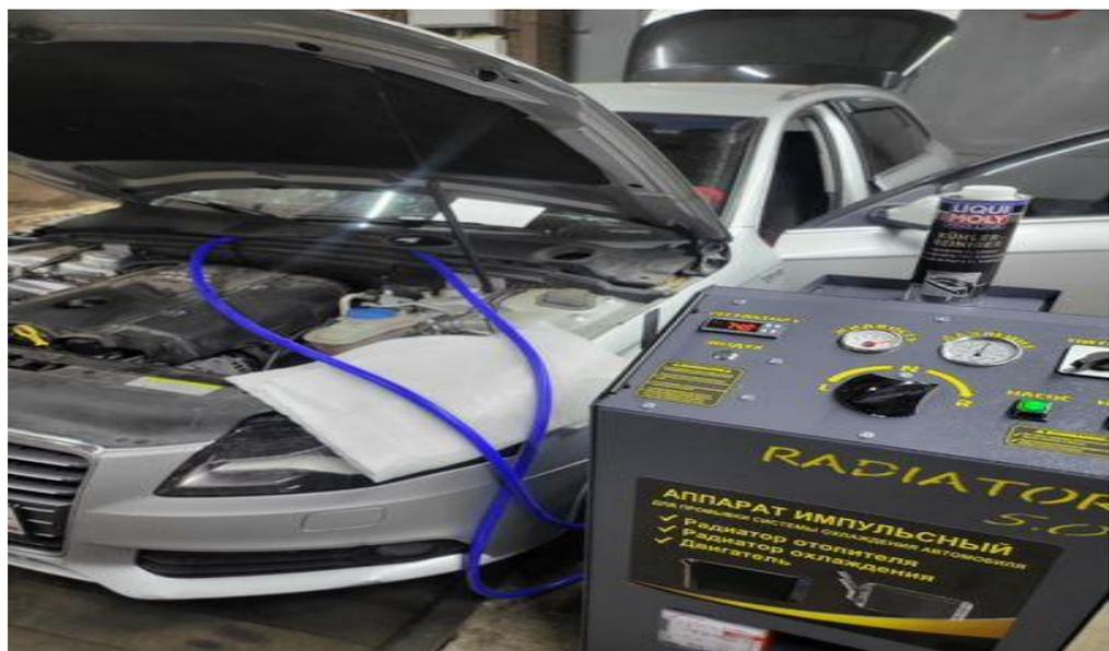
Рисунок 1.33 – Импульсная очистка радиатора под давлением
