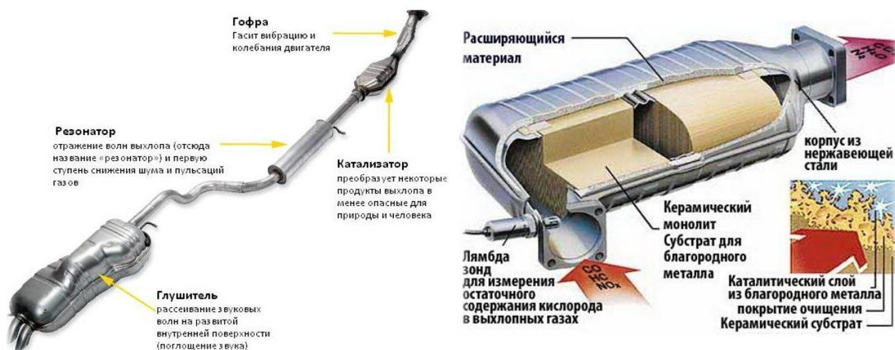
Рисунок 1.12 – Выхлопная система
