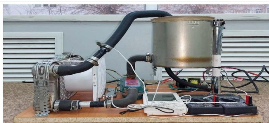
Рисунок 2.6 – Экспериментальный стенд для ультразвуковой очистки автомобильных радиаторов
