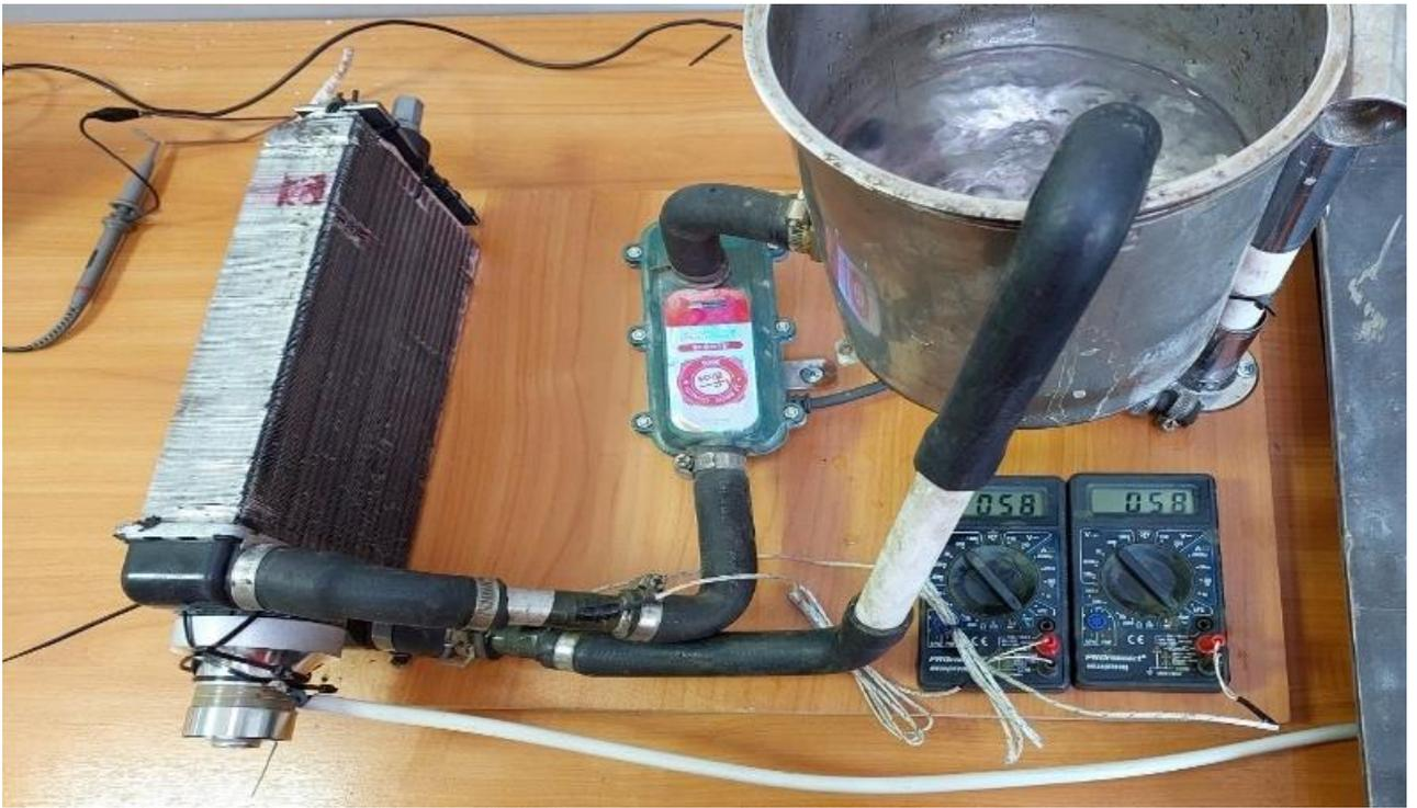
Рисунок 3.3 – Модернизированный экспериментальный стенд по очистке трубок радиатора
