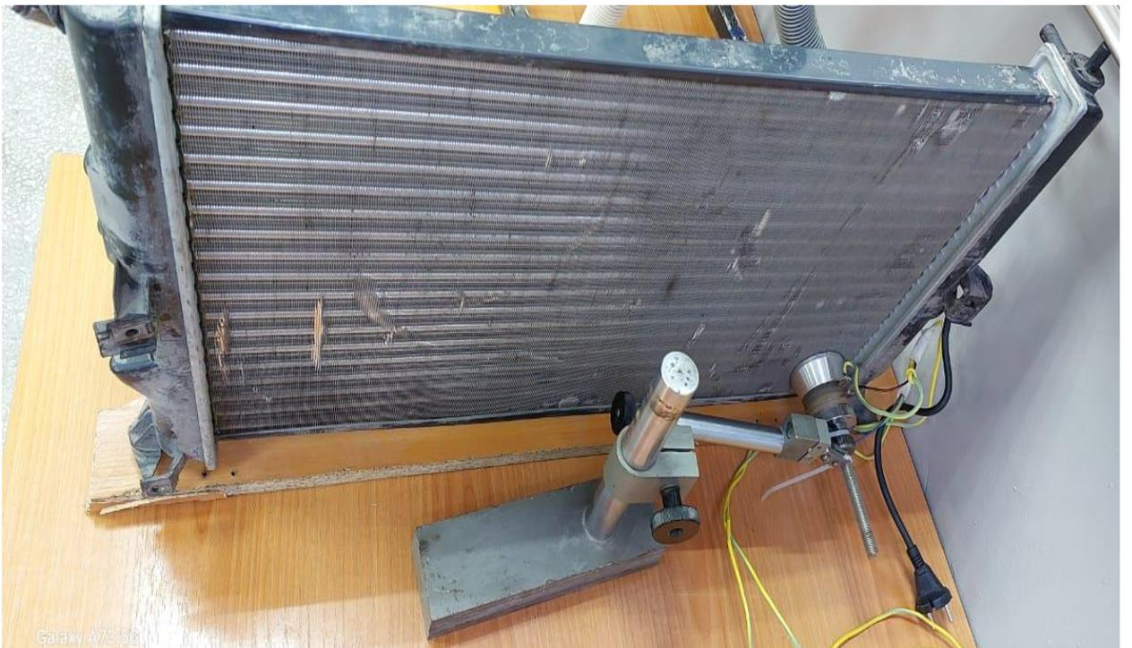
Рисунок 3.9 – Установка ультразвукового излучателя на радиатор
