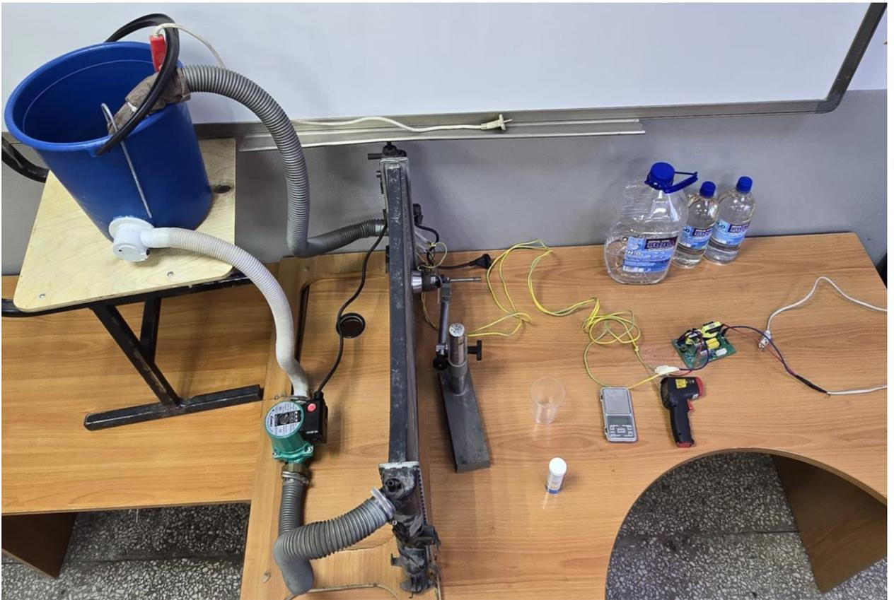
Рисунок 3.8 – Собранная установка для очистки радиатора
