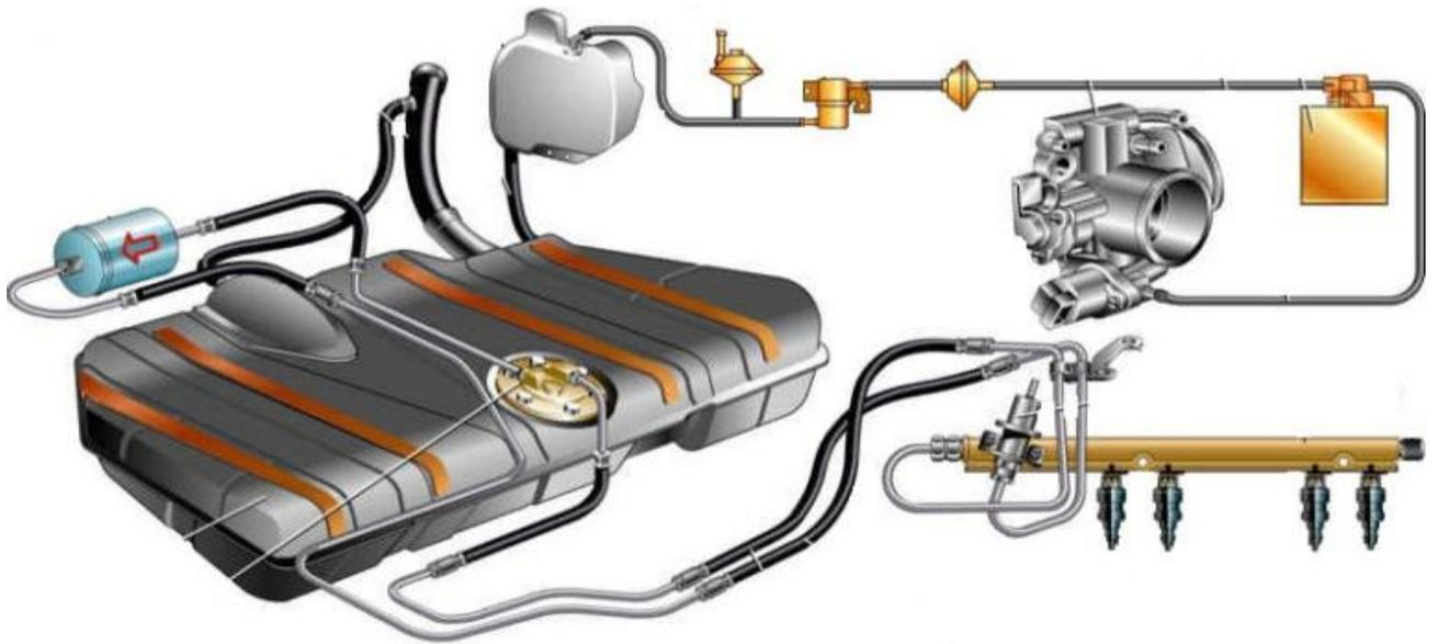
Рисунок 1.8 – Система впрыска топлива бензинового двигателя
