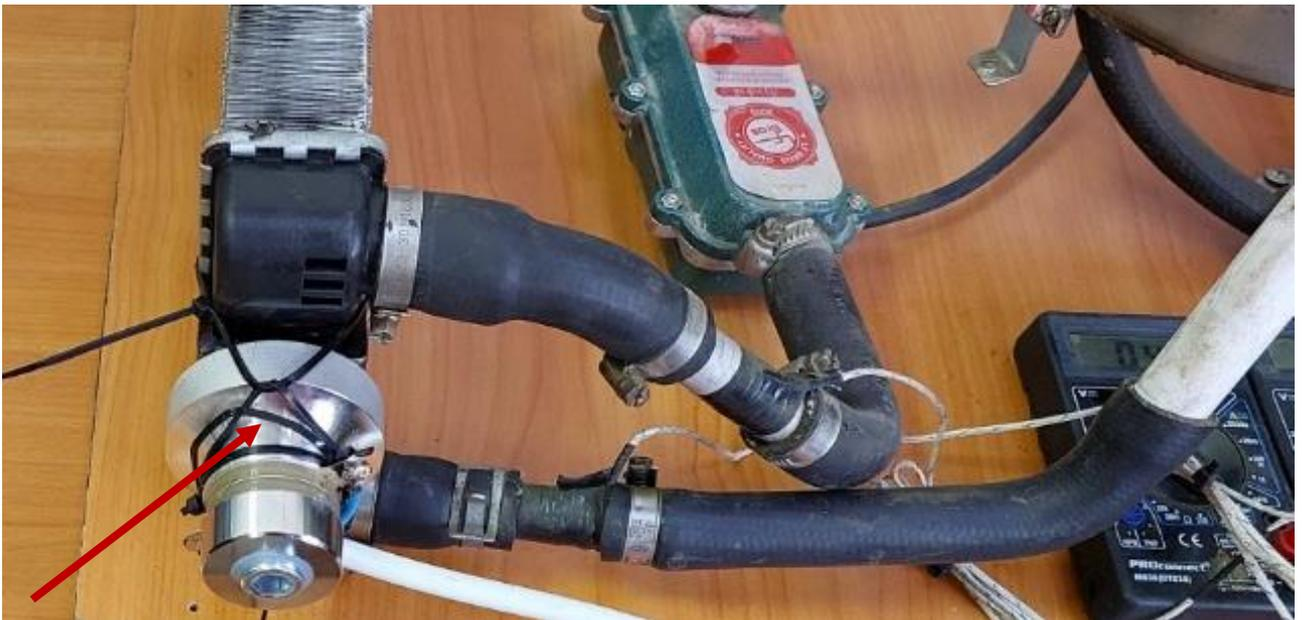
Рисунок 3.4 – Установленный ультразвуковой излучатель на радиатор
