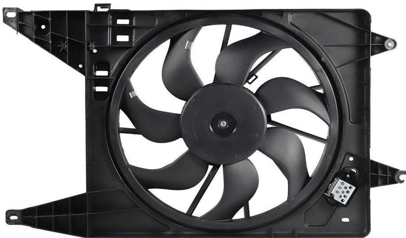
Рисунок 1.27 – Электрический вентилятор системы охлаждения автомобиля
