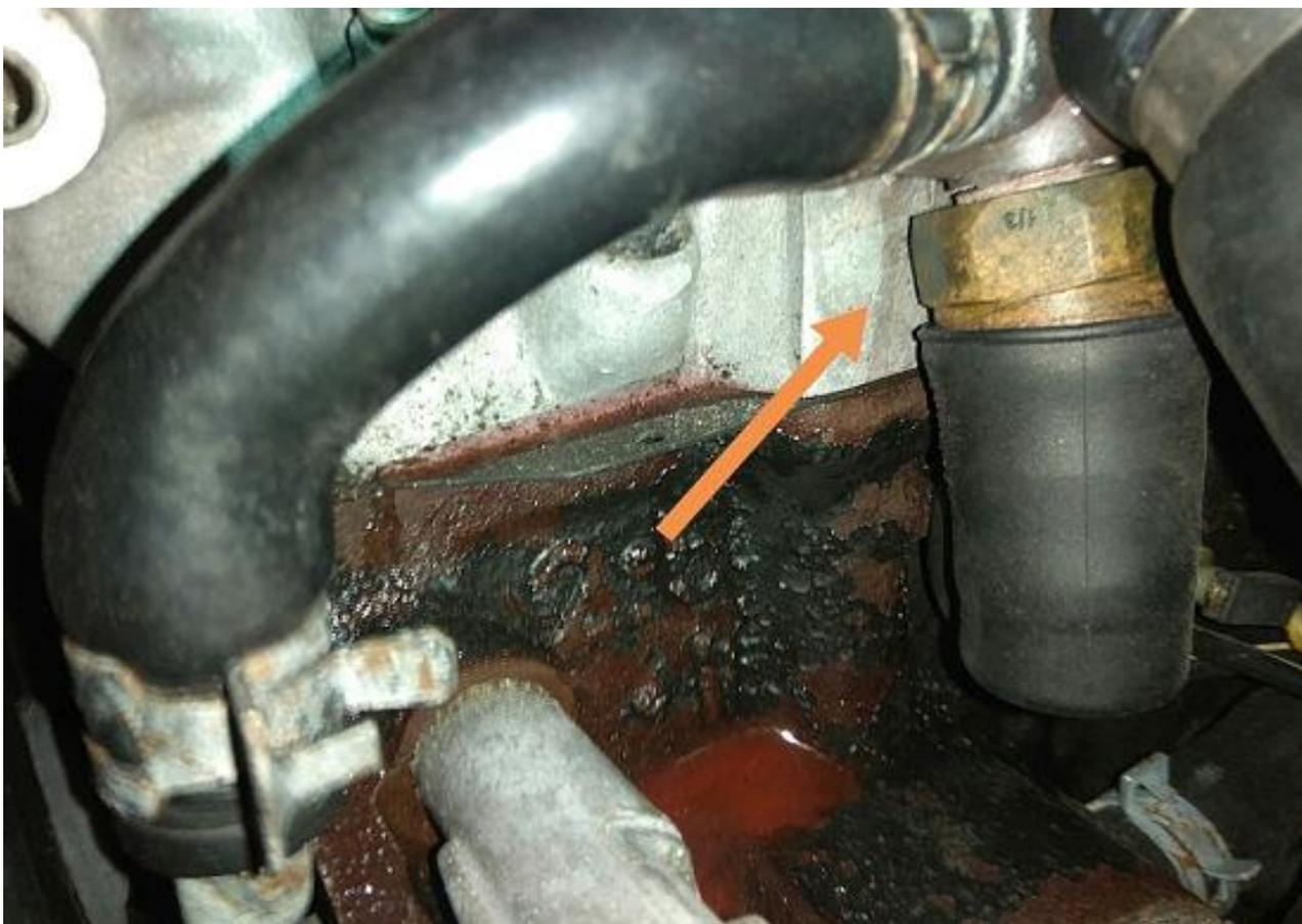
Рисунок 1.28 – Утечка охлаждающей жидкости
