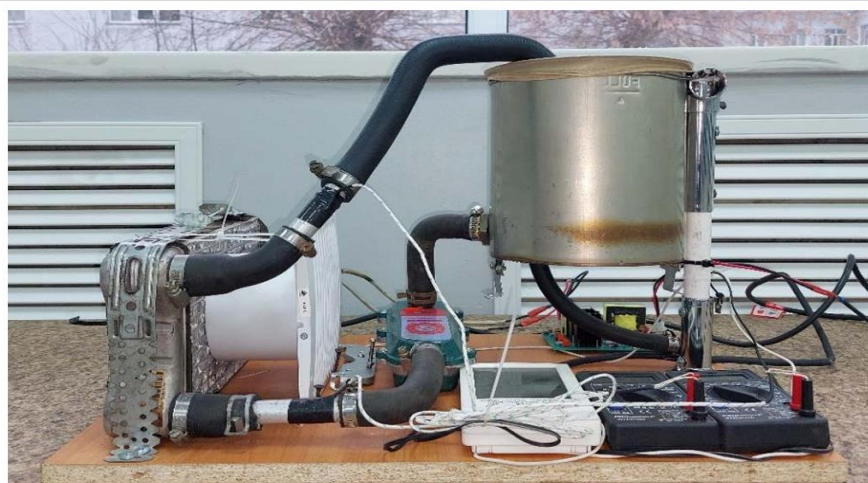
Рисунок 2.6 – Экспериментальный стенд для ультразвуковой очистки автомобильных радиаторов
