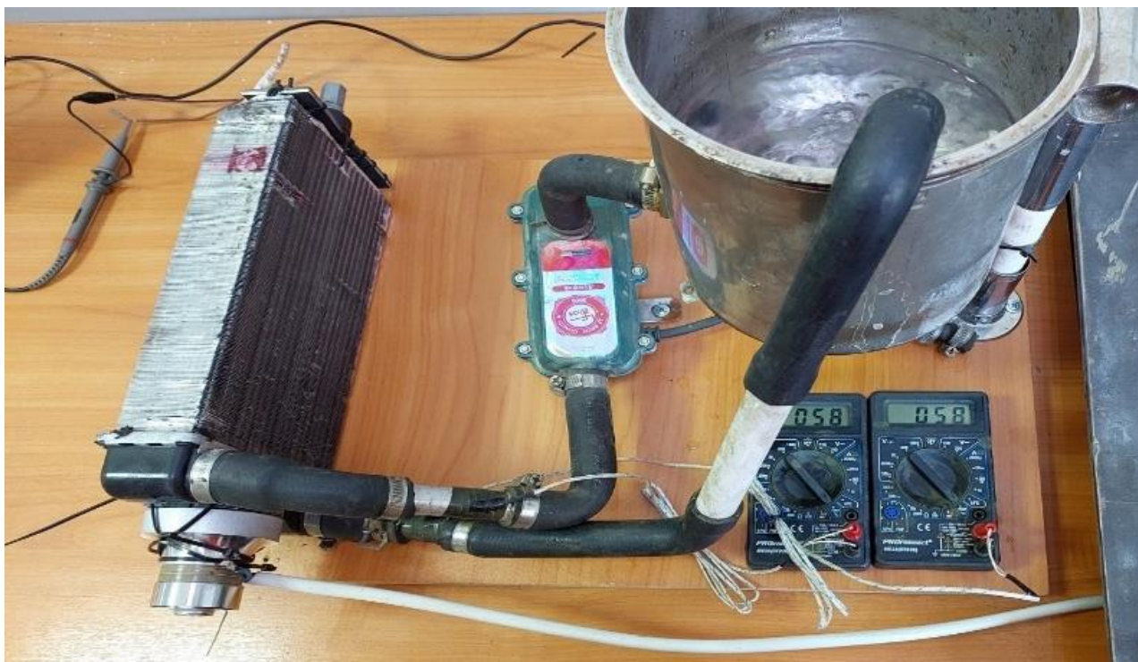
Рисунок 3.3 – Модернизированный экспериментальный стенд по очистке трубок радиатора
