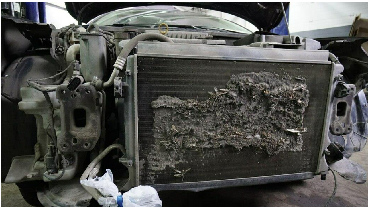
Рисунок 1.30 – Наружные загрязнения радиатора
