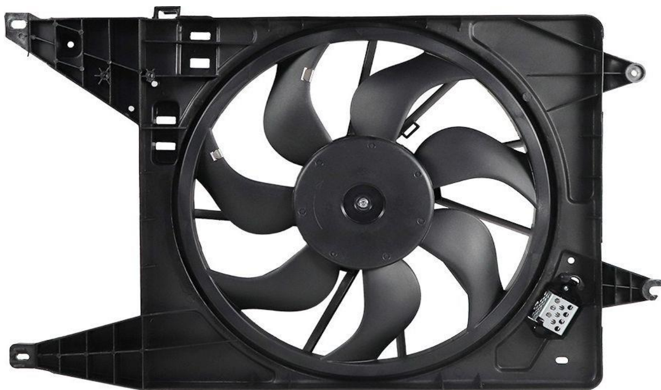
Рисунок 1.27 – Электрический вентилятор системы охлаждения автомобиля
