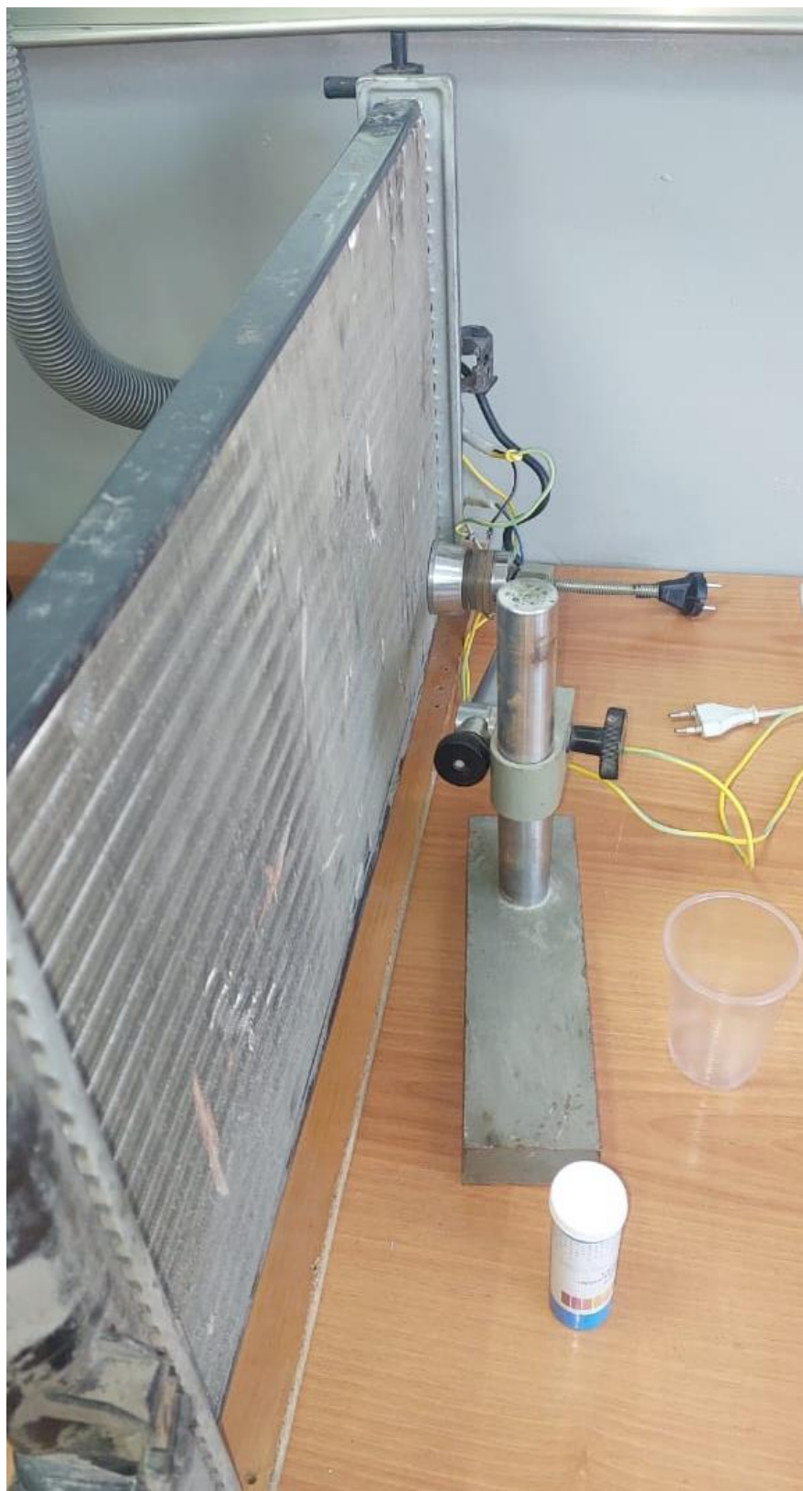
Рисунок 3.10 – Поперечное воздействие ультразвуком на радиатор
