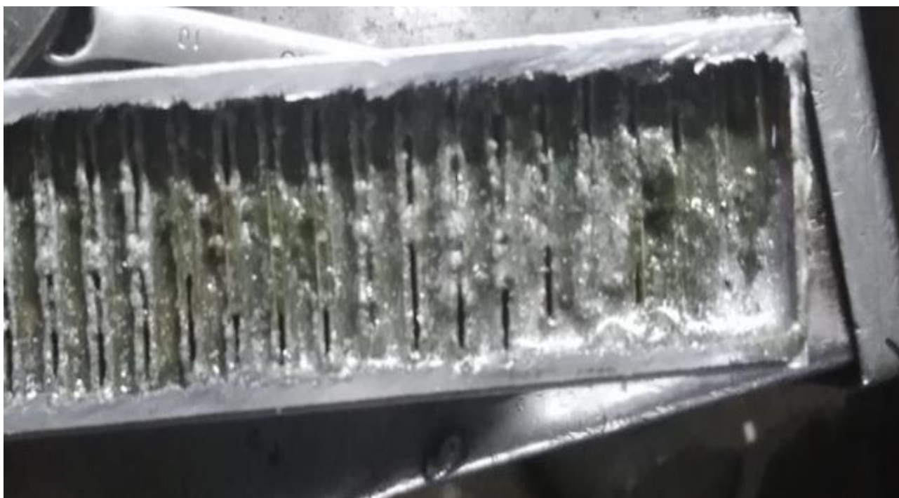
Рисунок 1.29 – Загрязнённые внутренние полости радиатора
