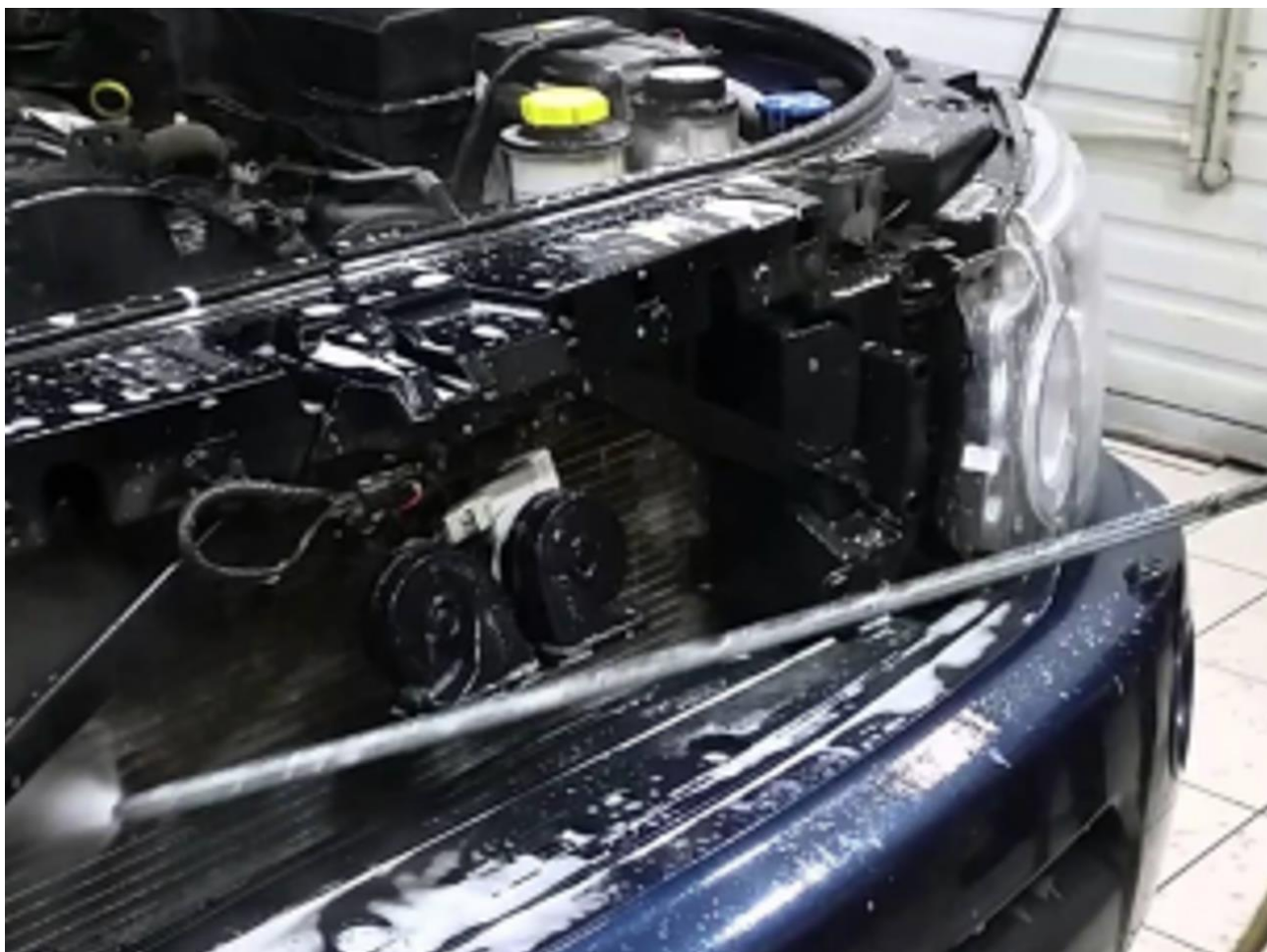
Рисунок 1.34 – Очистка радиатора снаружи
