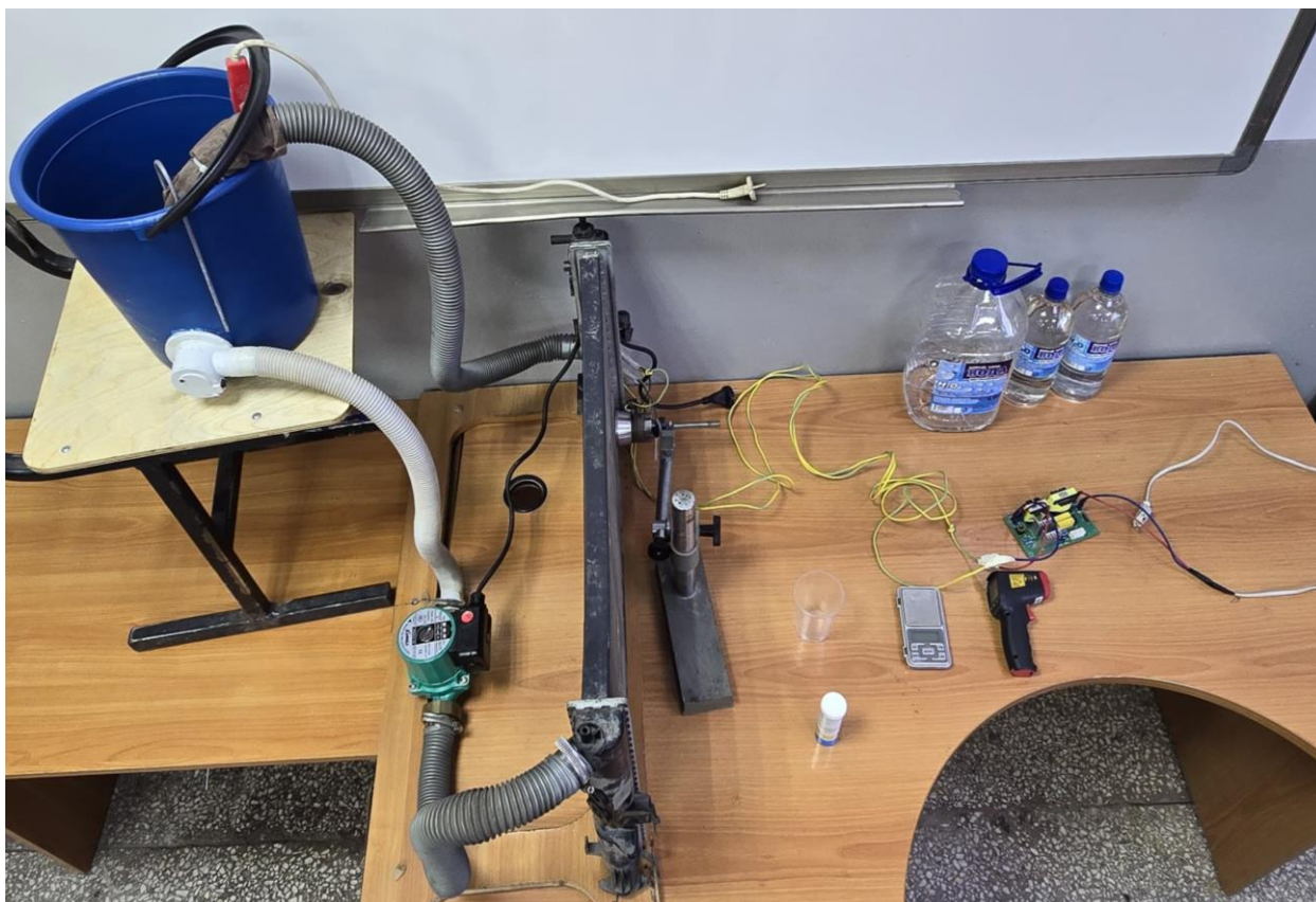
Рисунок 3.8 – Собранная установка для очистки радиатора
