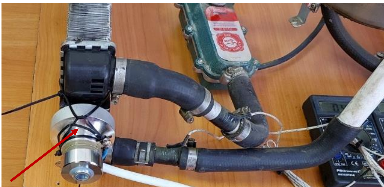
Рисунок 3.4 – Установленный ультразвуковой излучатель на радиатор
