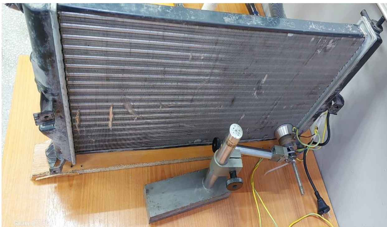
Рисунок 3.9 – Установка ультразвукового излучателя на радиатор
