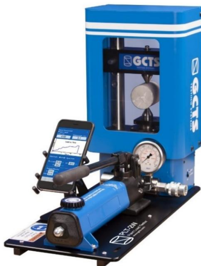
Сурет 2.11 – GCTS PLT-2W нүктелік жүктеу сынақ құрылғысы
