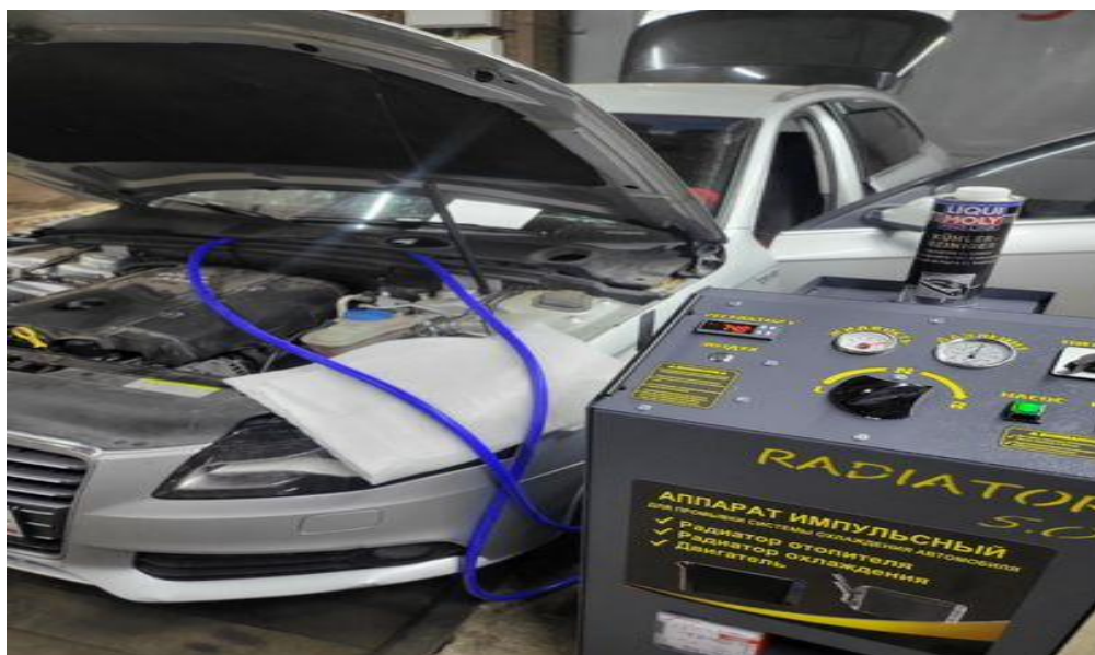
Рисунок 1.33 – Импульсная очистка радиатора под давлением
