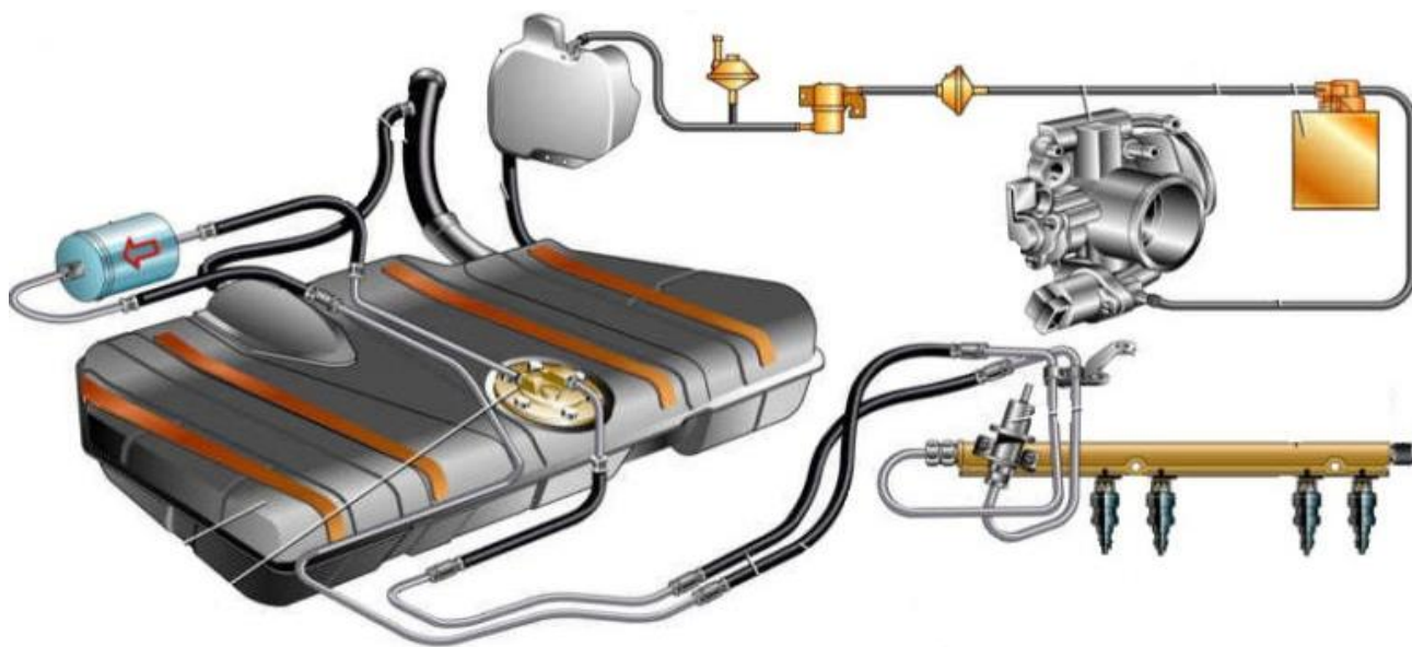
Рисунок 1.8 – Система впрыска топлива бензинового двигателя
