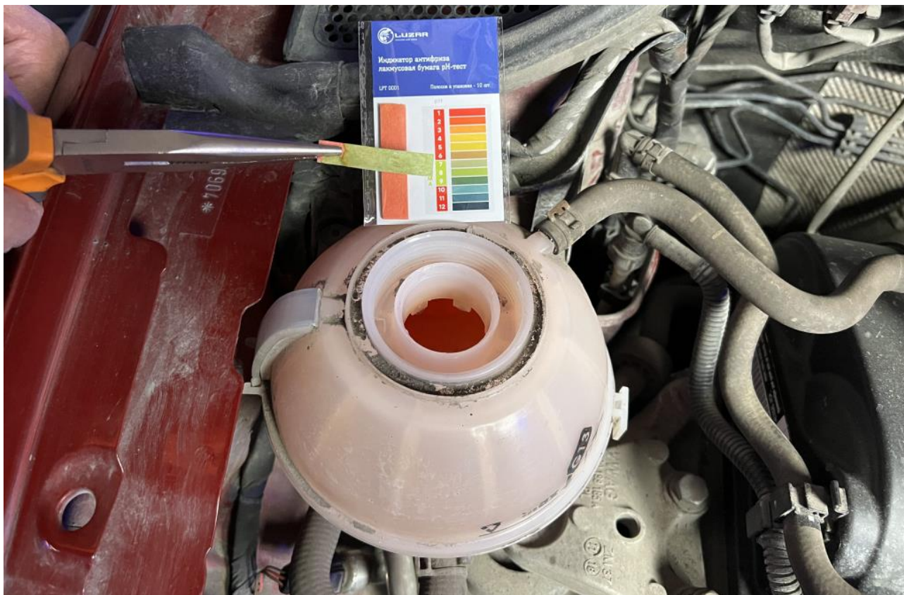
Рисунок 1.35 – Проверка состояния охлаждающей жидкости
