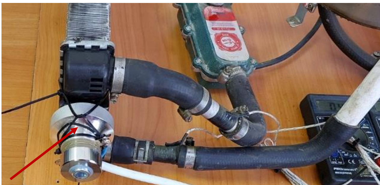
Рисунок 3.4 – Установленный ультразвуковой излучатель на радиатор
