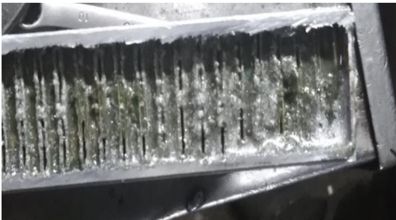
Рисунок 1.29 – Загрязнённые внутренние полости радиатора
