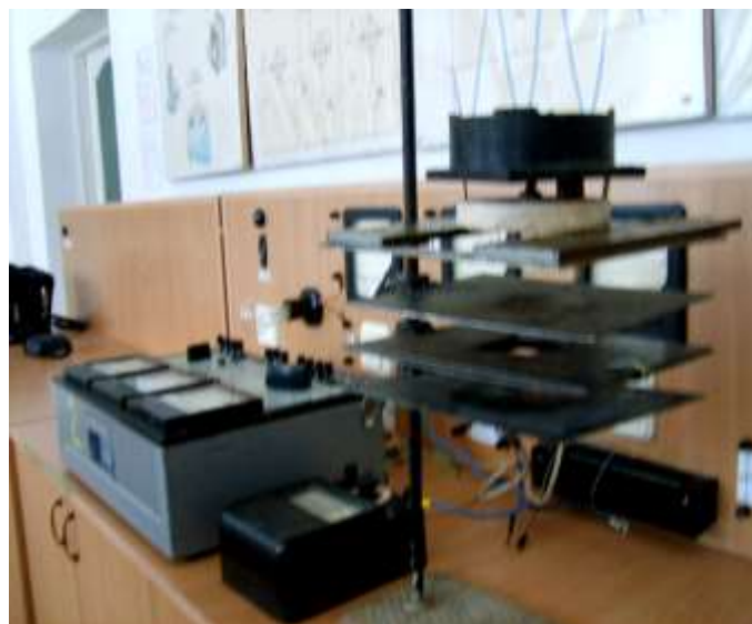
10 сурет – А.Ф. Чижскийдің экспресс-әдісі бойынша саздың кептіруге сезімталдығының коэффициентін анықтау бойынша әзірленген зертханалық қондырғы
