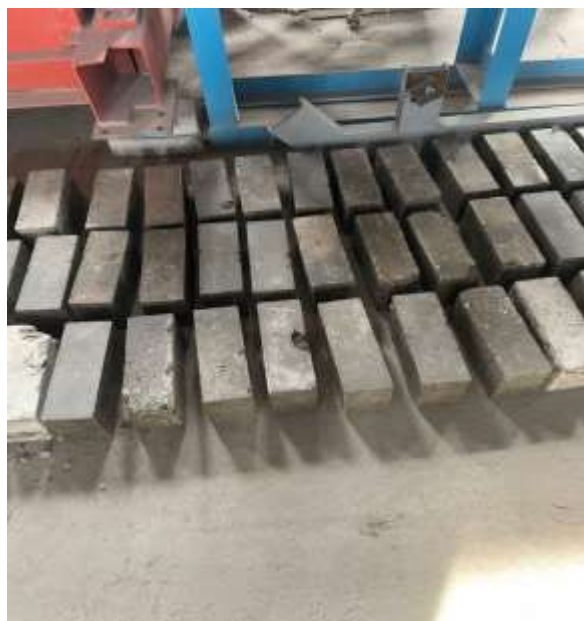
43 сурет - Кремнийлі жыныс - опока негізінде қабырға керамикасын өндірудің технологиялық схемасы, қалыпталған қам кірпіштер табиғи кептіру процесінде
