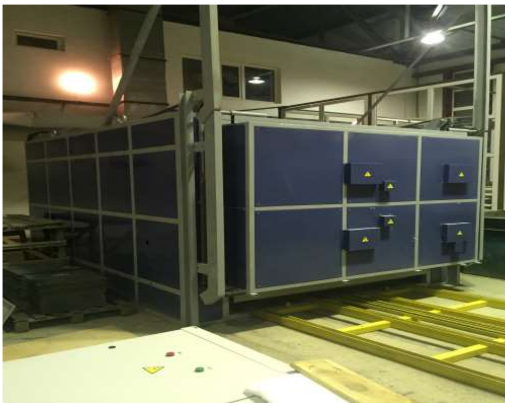
44-сурет - Жылжымалы паллетті СИКРОН П-2000x3000x1500, t-1150 РЭ маркалы камералы кедергілі пеш
