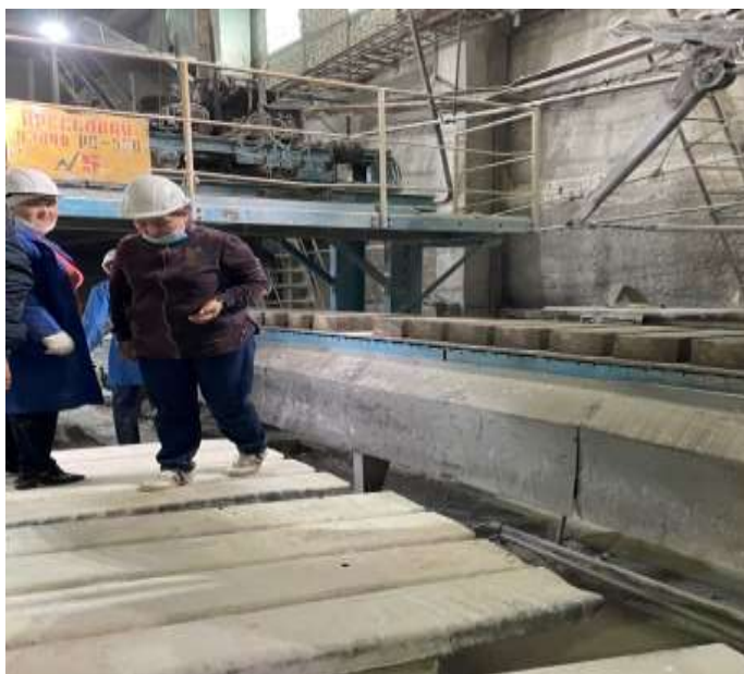
41-сурет - Кремнийлі жыныс - опока негізінде кірпішті қалыптау процесі
