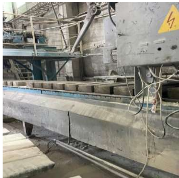
41-сурет - Кремнийлі жыныс - опока негізінде кірпішті қалыптау процесі
