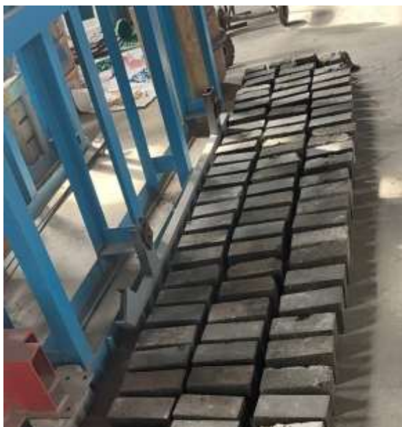
43 сурет - Кремнийлі жыныс - опока негізінде қабырға керамикасын өндірудің технологиялық схемасы, қалыпталған қам кірпіштер табиғи кептіру процесінде
