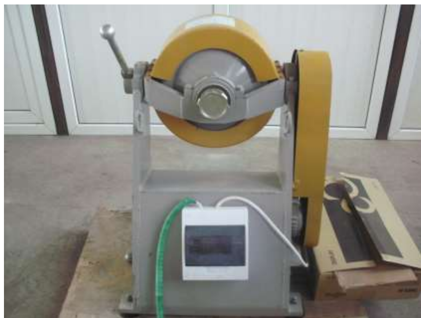
13-сурет – МШЛ 250x100 маркалы зертханалық шарлы диірмен
