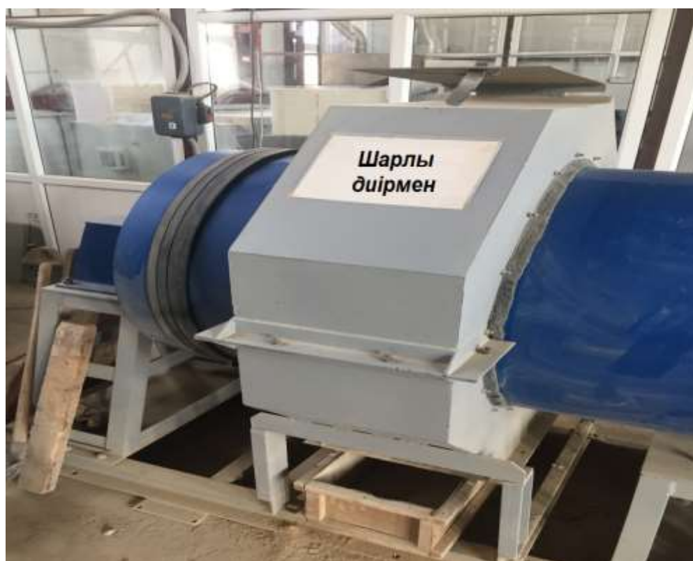
35 сурет - Шикізат материалдарын үтуге арналған шарлы диірмен
