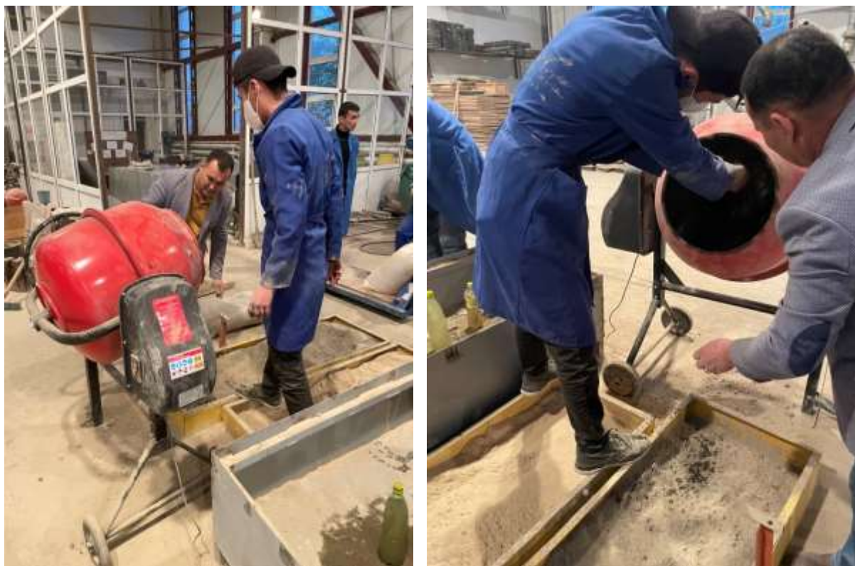
36 сурет - Шикізат қоспаларын араластыру процесі
