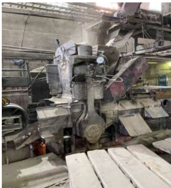
38-сурет - Жартылай құрғақ нығыздау бункеріне беру үшін шикізатты дайындау процесі
