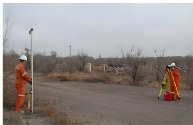
2-сурет – Репер бойынша жер бетінің шөгуін өлшеу
