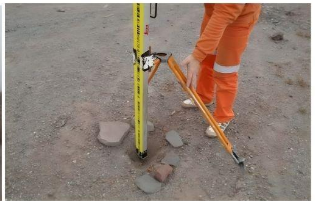
2-сурет – Репер бойынша жер бетінің шөгуін өлшеу
