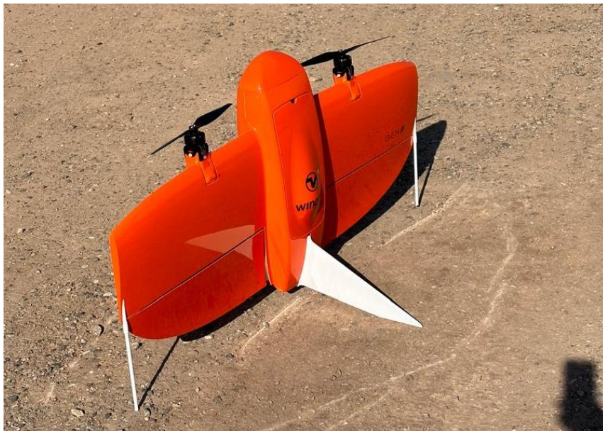
Рисунок 6— Вертикально взлетающий БПЛА для детализированной аэрофотосъемки.
