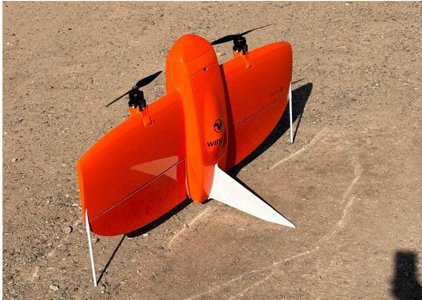
6-сурет -Егжей-тегжейлі аэрофототүсірілім үшін тігінен ұшатын ұшқышсыз ұшу аппараттары.
