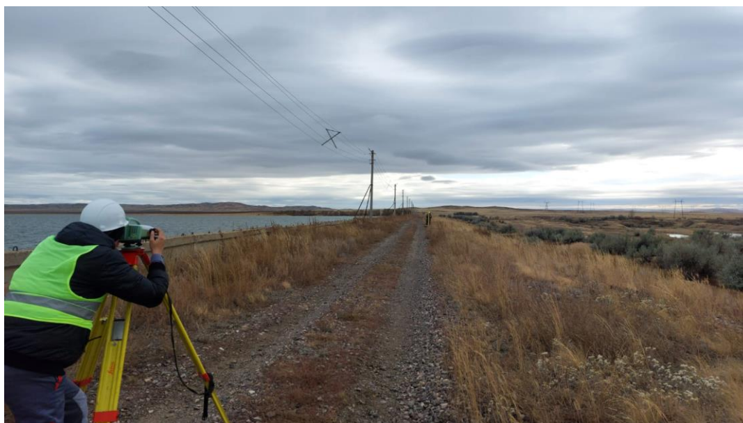
5 - сурет- Нивелирлеу-сандық модельдерді тексерудің және бақылаудың маңызды кезеңі.
