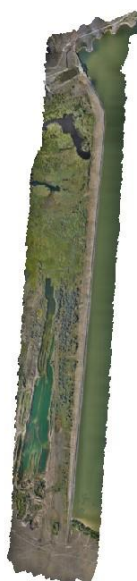
1 – сурет- Wingtra One UAV көмегімен аэрофототүсірілім нәтижесінде алынған Ортофотоплан
