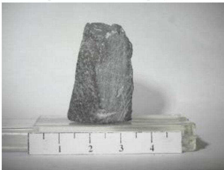
Рисунок 2.28 -Риолит темно-серого цвета с реликто-порфировой структурой. Штуфной образец
