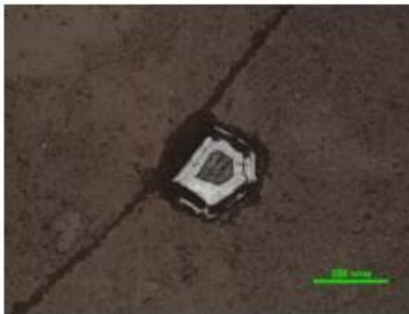
Рисунок 2.42 – Псевдоморфоза гидроксидов Fe по пириту Полированный шлиф
