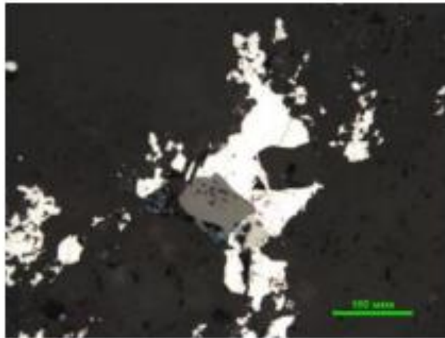
Рисунок 2.48 – Галенит в сростках со сфалеритом и блёклой рудой. Замещение сфалерита ковеллином. Полированный шлиф
