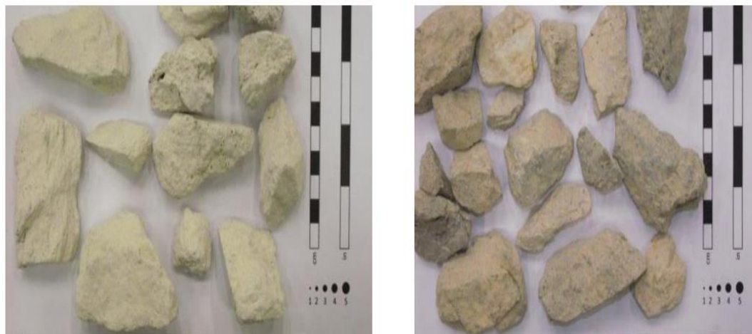
Рисунок 2.15 - Фотографии проб восточной и западной окисленных руд
